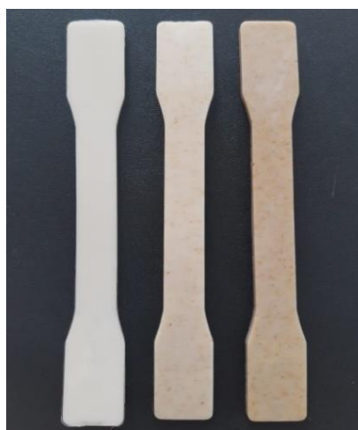
Figura 21 - Corpos de prova tipo gravata para ensaio de tração.
