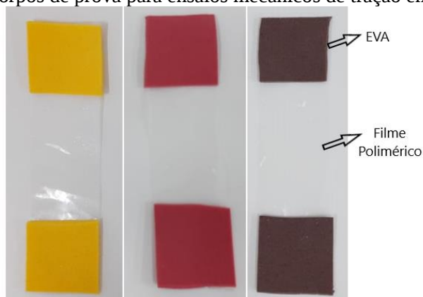
Figura 20 - Corpos de prova para ensaios mecânicos de tração em filmes.
