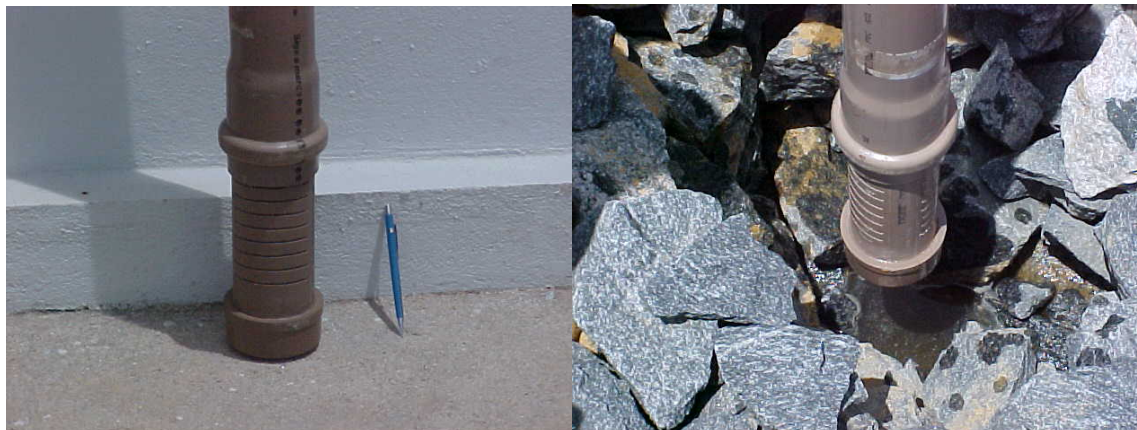
Figura 3.10 - Detalhe do Piezômetro.
