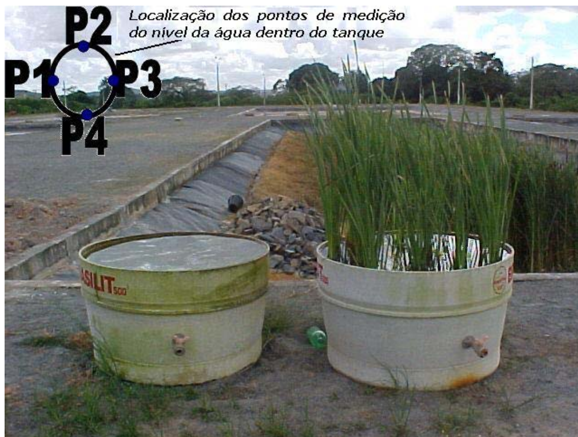
Figura 4.7 - Tanques usados no experimento para medir o potencial da evapotranspiração das Taboas.
