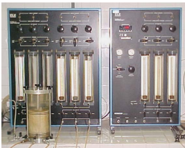
Figura 4.5 - Permeômetro de Parede flexível Tri-Flex.
