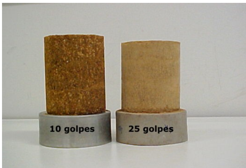
Figura 5.44 - Corpos-de-prova confeccionados no molde usado no ensaio de Proctor, com 10 e 25 golpes de soquete.
