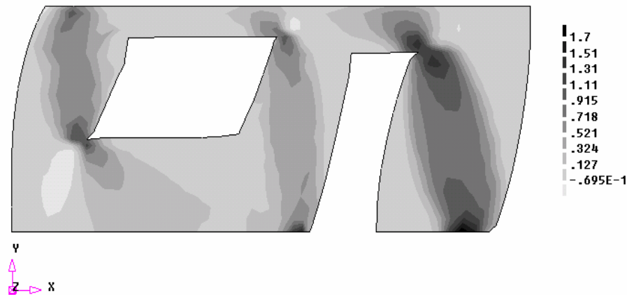
Figura 8:15 - Distribuição das tensões de cisalhamento na fase de pós pico – Modelo I-B – Caso II – F+X N/mm 2
