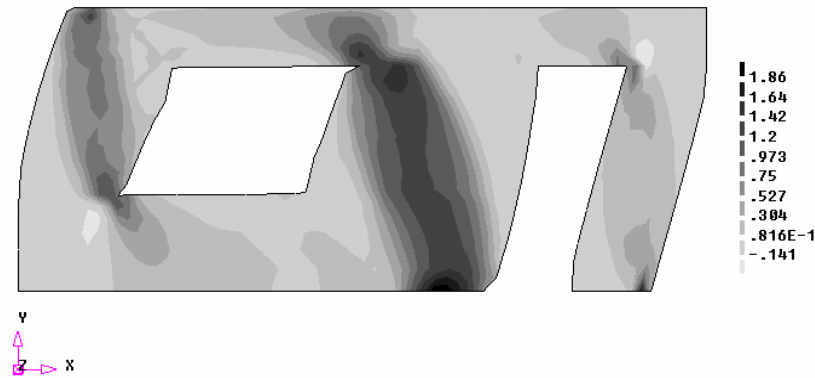
Figura 8:28 - Distribuição das tensões de cisalhamento na fase de pós pico - Modelo III - Caso II - F+X N/mm 2
