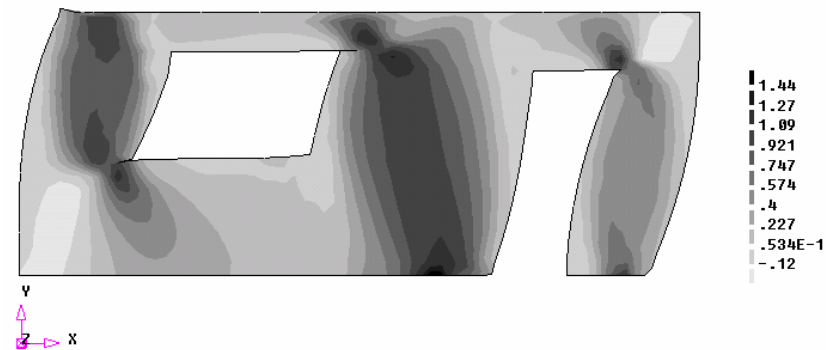
Figura 8:106 - Distribuição das tensões de cisalhamento na fase de pós pico - Modelo III-B - Caso III - F+X N/mm2
