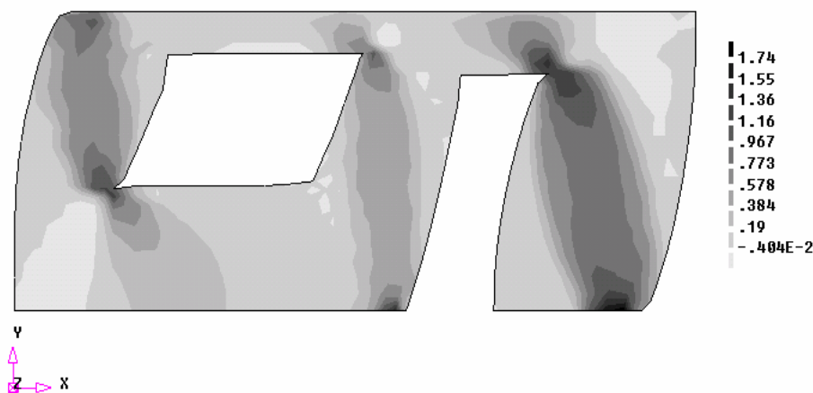
Figura 8:13 - Distribuição das tensões de cisalhamento na fase de pico - Modelo I-B - Caso II - F+X - N/mm 2
