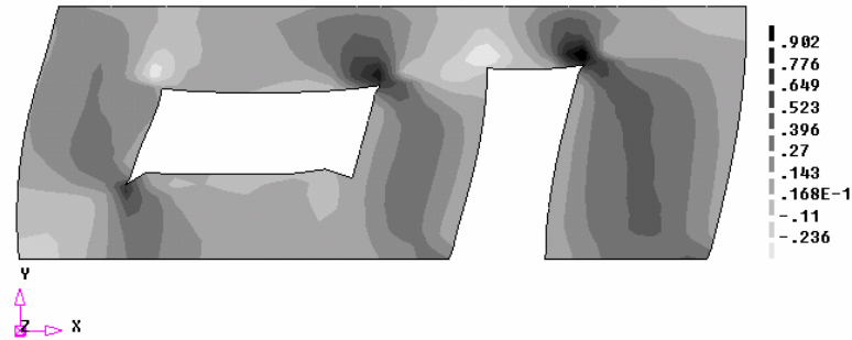
Figura 8:70 - Distribuição das tensões de cisalhamento na fase de Fmax/2 – Modelo I-A – Caso III - F+X – N/mm 2
