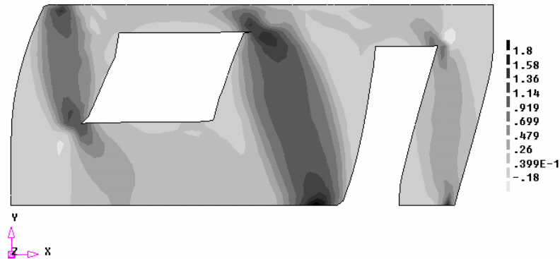
Figura 8:40 - Distribuição das tensões de cisalhamento na fase de pico - Modelo III-B - Caso II - F+X - N/mm 2
