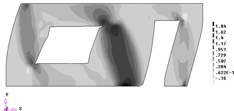
Figura 8:35 - Distribuição das tensões de cisalhamento na fase de pós pico - Modelo III-A - Caso II - F+X N/mm 2
