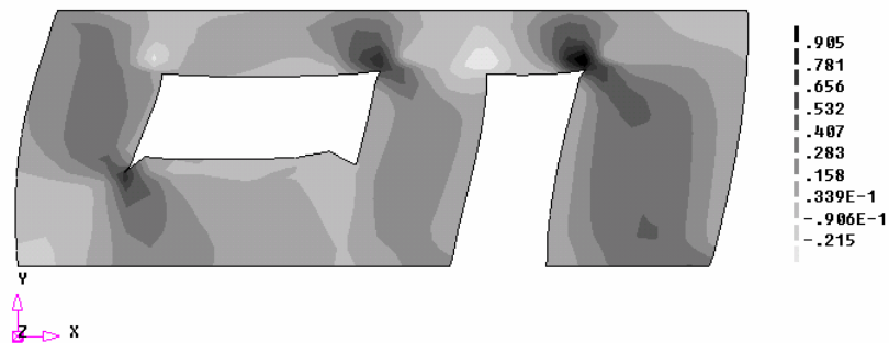
Figura 8:63 - Distribuição das tensões de cisalhamento na fase de F_{max}/2 - Modelo I - Caso III - F+X - N/mm^2
