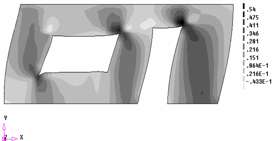
Figura 8:8 - Distribuição das tensões de cisalhamento na fase de F_{max}/2 - Modelo I-A - Caso II - F+X - N/mm^2
