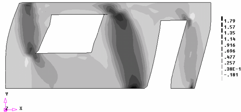
Figura 8:42 - Distribuição das tensões de cisalhamento na fase de pós pico - Modelo III-B - Caso II - F+X N/mm 2
