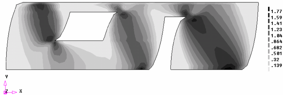
Figura 8:85 - Distribuição das tensões de cisalhamento na fase de pós pico – Modelo II Caso III – F+X N/mm 2
