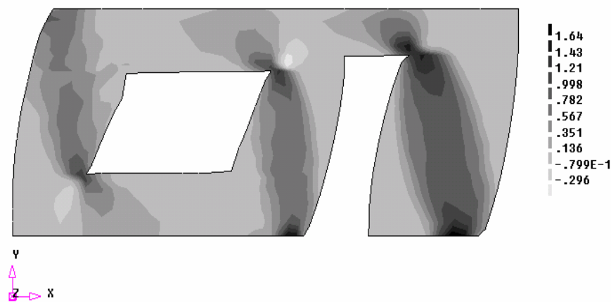
Figura 8:7 - Distribuição das tensões de cisalhamento na fase de pico - Modelo I-A - Caso II - F+X - N/mm 2
