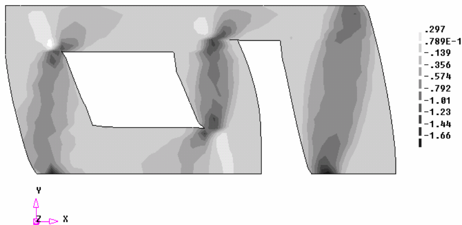
Figura 8:12 - Distribuição das tensões de cisalhamento na fase de pós pico – Modelo I-A – Caso II – F-X N/mm 2
