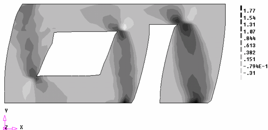
Figura 8:9 - Distribuição das tensões de cisalhamento na fase de pós pico – Modelo I-A – Caso II – F+X N/mm 2
