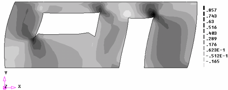
Figura 8:77 - Distribuição das tensões de cisalhamento na fase de Fmax/2 - Modelo I-B - Caso III - F+X - N/mm²
