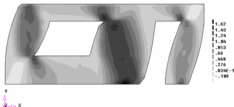
Figura 8:90 - Distribuição das tensões de cisalhamento na fase de pico - Modelo III - Caso III - F+X - N/mm2
