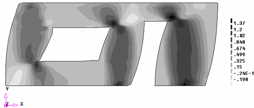
Figura 8:71 - Distribuição das tensões de cisalhamento na fase de pós pico - Modelo I-A Caso III - F+X N/mm 2
