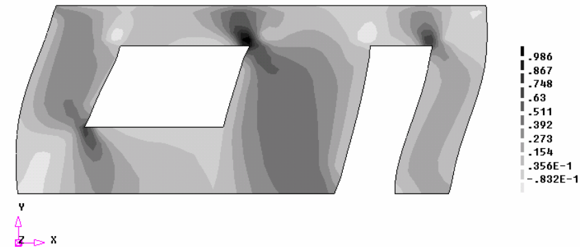
Figura 8:91 - Distribuição das tensões de cisalhamento na fase de Fmax/2 - Modelo III - Caso III - F+X - N/mm2
