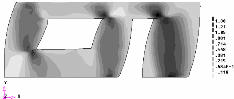
Figura 8:64 - Distribuição das tensões de cisalhamento na fase de pós pico - Modelo I - Caso III - F+X N/mm^2
