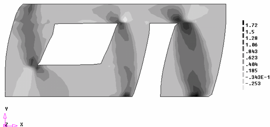
Figura 8:3 - Distribuição das tensões de cisalhamento na fase de pós pico - Modelo I - Caso II - F+X N/mm 2
