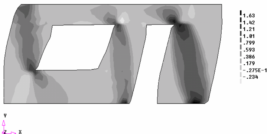
Figura 8:1 - Distribuição das tensões de cisalhamento na fase de pico – Modelo I – Caso II - F+X – N/mm 2
