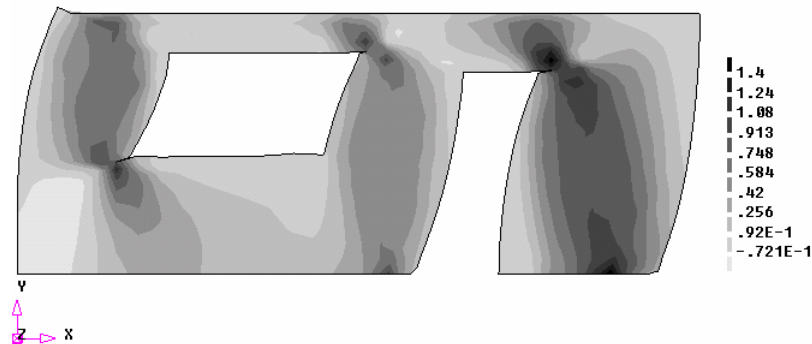
Figura 8:78 - Distribuição das tensões de cisalhamento na fase de pós pico - Modelo I-B Caso III - F+X N/mm²
