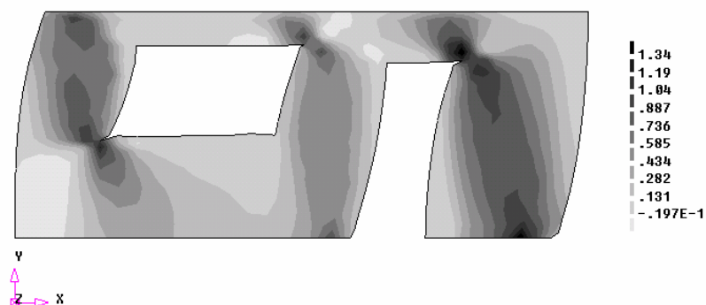
Figura 8:76 - Distribuição das tensões de cisalhamento na fase de pico - Modelo I-B - Caso III - F+X - N/mm 2
