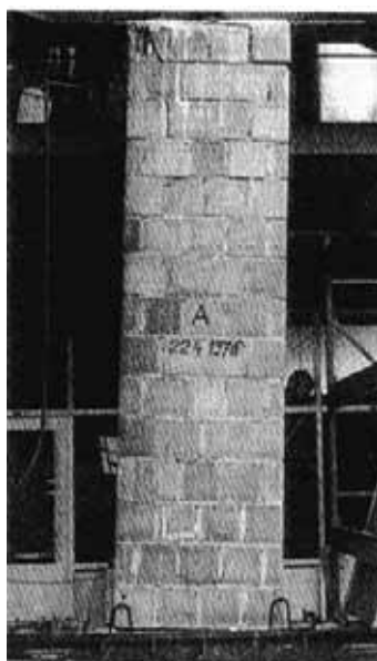
Figura 4:19 – Ruptura por flexão de um membro vertical esbelto de alvenaria não armada
