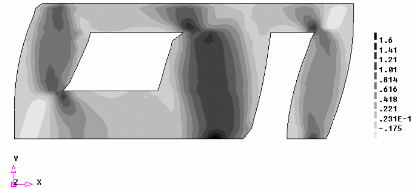
Figura 8:92 - Distribuição das tensões de cisalhamento na fase de pós pico - Modelo III Caso III - F+X N/mm2
