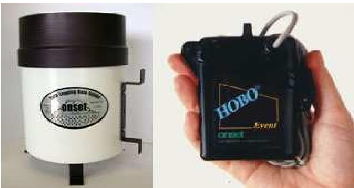
Figura 4. 1 – Equipamento automtico adotado.
