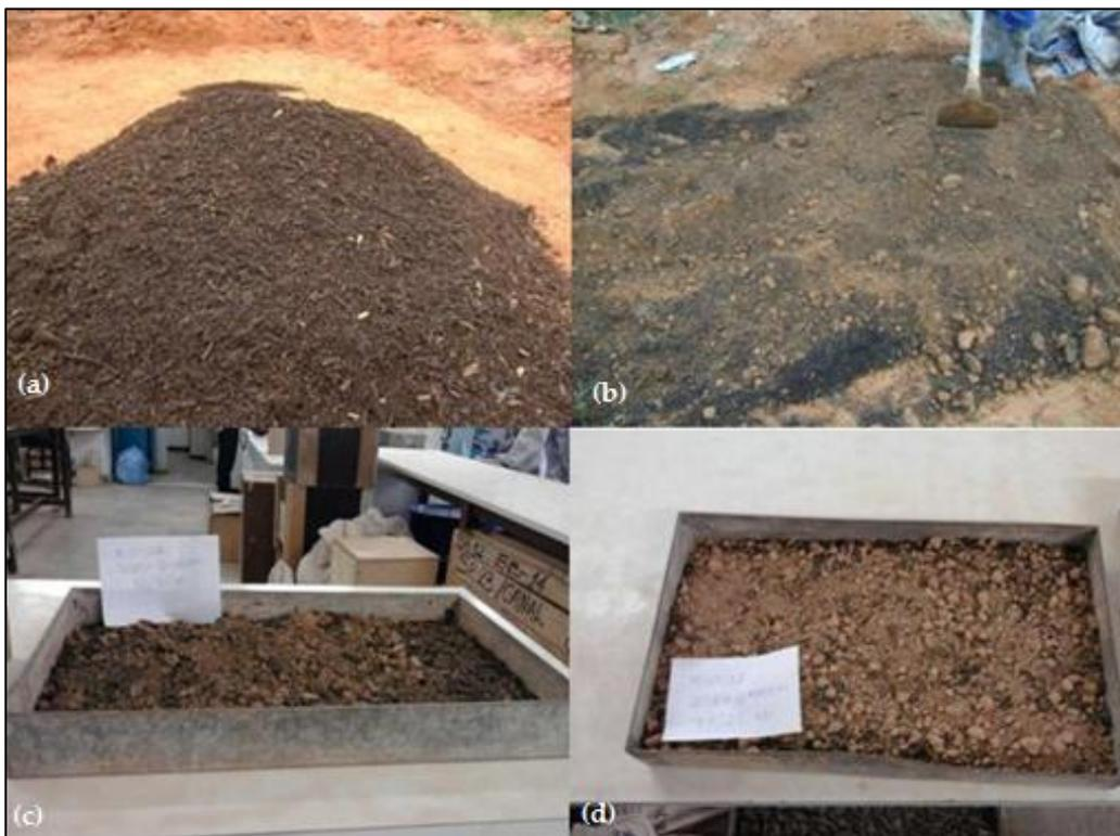
**Figura 39: Material utilizado no infiltrômetro da camada metanotrófica (a) composto *in natura* (b) Mistura de solo e composto MET01 em campo (c) e (d) amostras da MET01 e MET02 para análise em laboratório.**
