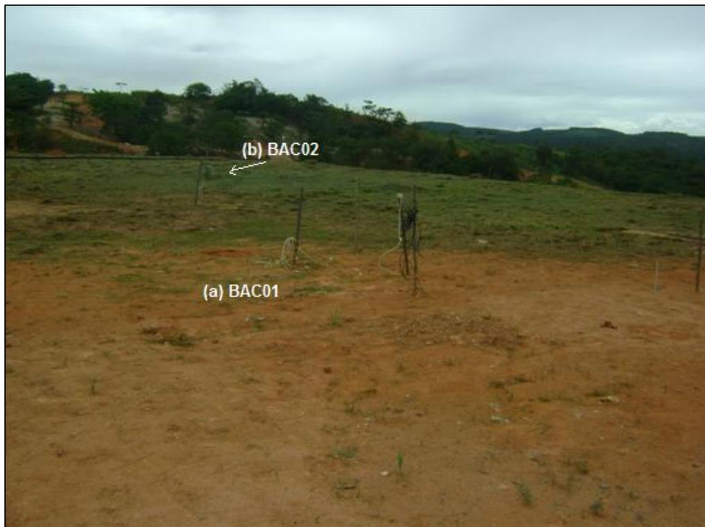
Figura 122: Perfis de medição de concentração e pressão na barreira capilar (a) sem vegetação (b) com vegetação
