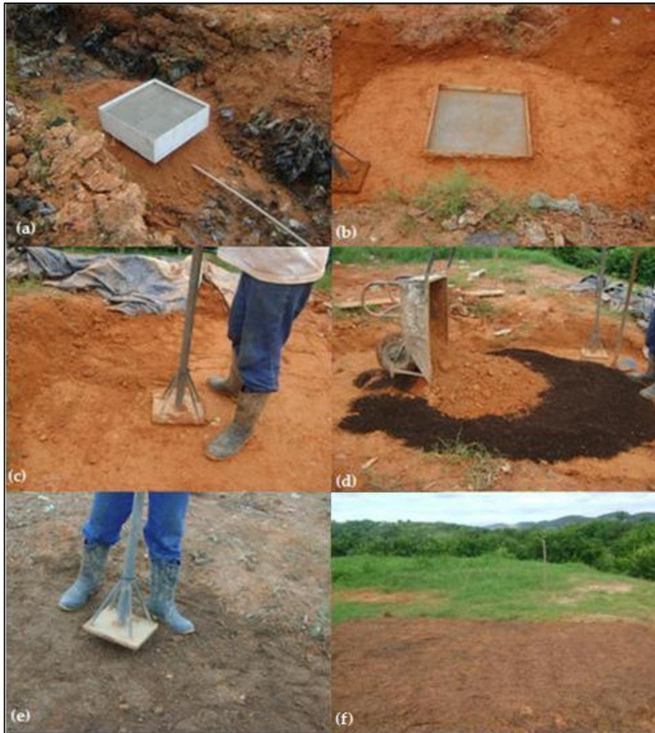
**Figura 54: Instalação do infiltrômetro da camada metanotrófica (a) fixação da base (b) compactação ao redor da base (c) compactação da camada inferior (d) mistura de solo e composto (50%) (e) compactação da camada superior (f) conclusão da instalação**
