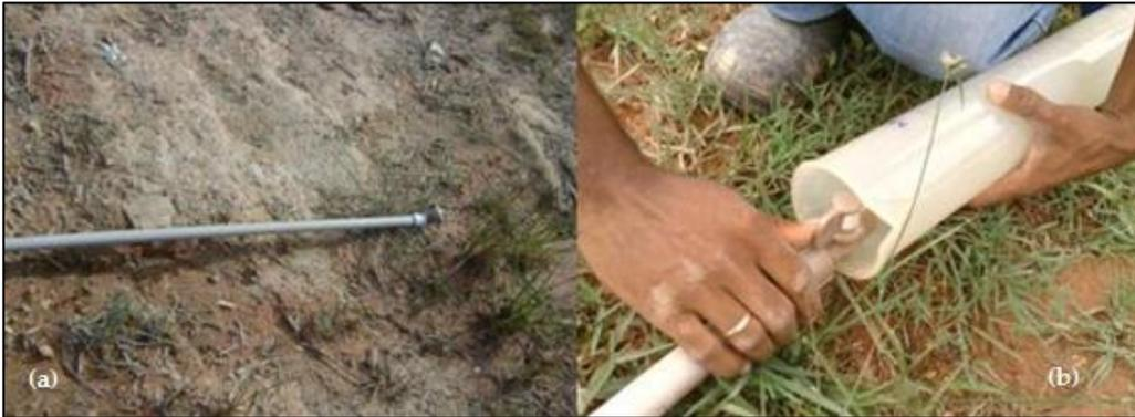
**Figura 57: Medição de água infiltrada (a) tubulação de saída (b) medição com proveta**
