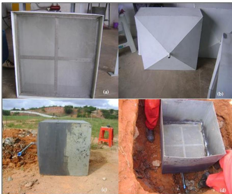
**Figura 51: Detalhes do infiltrômetro instalado na barreira capilar (a) tela na base (b) base para captação de água em formato de pirâmide invertida (c) vista lateral (d) vista superior**
