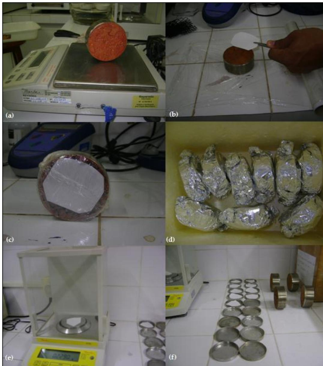
**Figura 42: Etapas do ensaio de curva de retenção: (a) pesagem inicial do corpo de prova (b) colocação do papel filtro (c) envolvimento com filme plástico (d) envolvimento com papel alumínio e colocação em caixa térmica durante 7 dias (e) pesagem do papel filtro (f) colocação do papel filtro em cápsulas para secagem e determinação de umidade**
