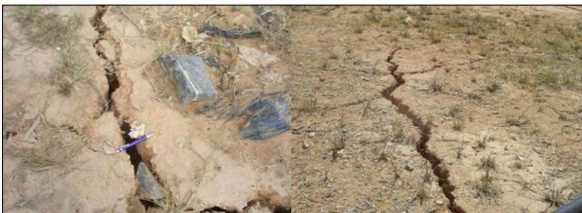
**Figura 113: Fissuras na camada MET02 em 04.12.2008 (primeiro período seco)**
