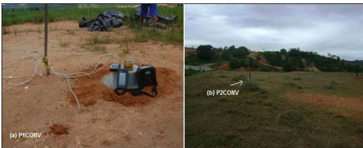
**Figura 127: Área dos perfis para medição de concentração e pressão de biogás instalado na camada convencional (a) sem vegetação (b) com vegetação**
