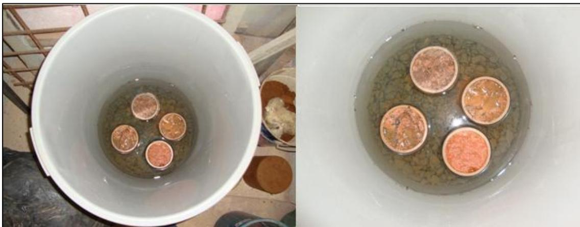
**Figura 47: Amostras saturando para determinação da capacidade de campo**
