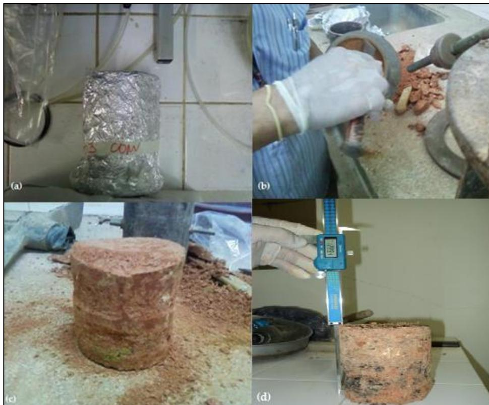
**Figura 44: Preparação do corpo de prova para ensaio de permeabilidade (a) amostra acondicionada (b) retirada do corpo de prova do molde (c) corpo de prova da camada convencional (d) medidas do corpo de prova**
