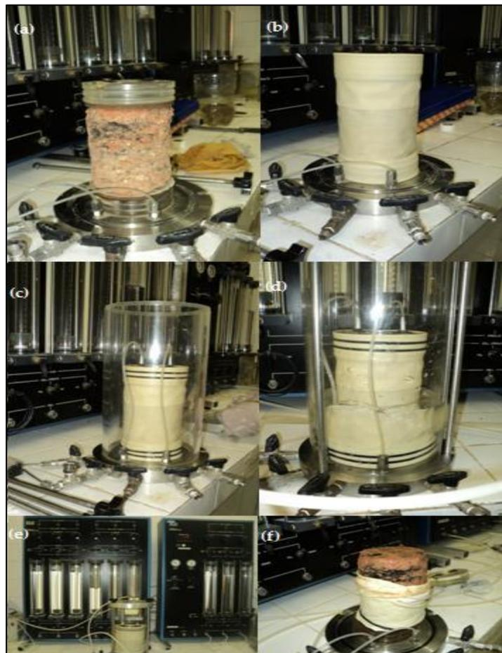
**Figura 45: Ensaio de permeabilidade à água: (a) montagem do corpo de prova (b) colocação de membrana (c) colocação de corpo de prova na célula (d) entrada de água para aplicação de pressão confinante (e) realização do ensaio (f) corpo de prova após ensaio**
