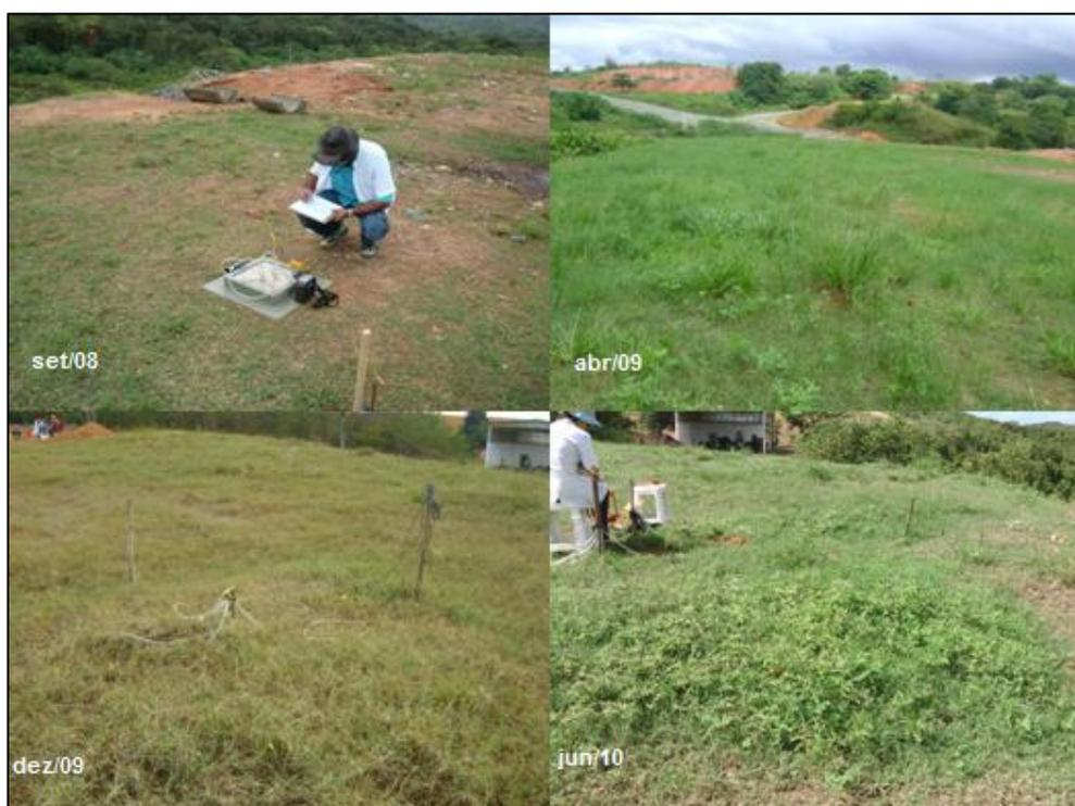
**Figura 85: Presença de vegetação na camada de cobertura MET01**
