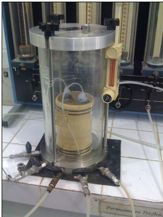
**Figura 46: Ensaio de permeabilidade ao ar com amostra CONV**
