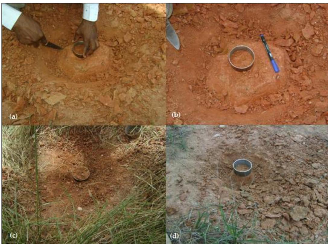
**Figura 40: Coleta de amostras para ensaios de curva característica (a) posicionamento do anel, (b) anel metálico cravado na camada convencional (c) e (d) anéis cravados nas camadas MET01 e MET02.**
