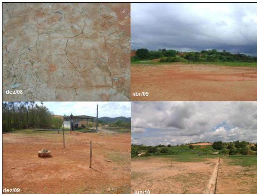
**Figura 99: Fissuras superficiais e ausência de vegetação na camada convencional**
