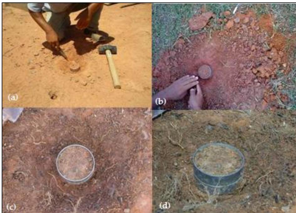
**Figura 66: Coleta de amostra pra determinação de umidade e peso específico (a) retirada de anel da camada convencional (b), (c) e (d) retirada de anel da camada metanotrófica**
