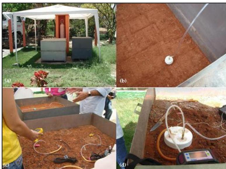
**Figura 70: Detalhe das caixas de fluxo (a) vista geral (b) colocação de medidores de concentração em profundidade (c) instrumentação para medidas de temperatura e umidade (d) ensaios de determinação de taxa de respiração de  $\text{CO}_2$  no substrato**
