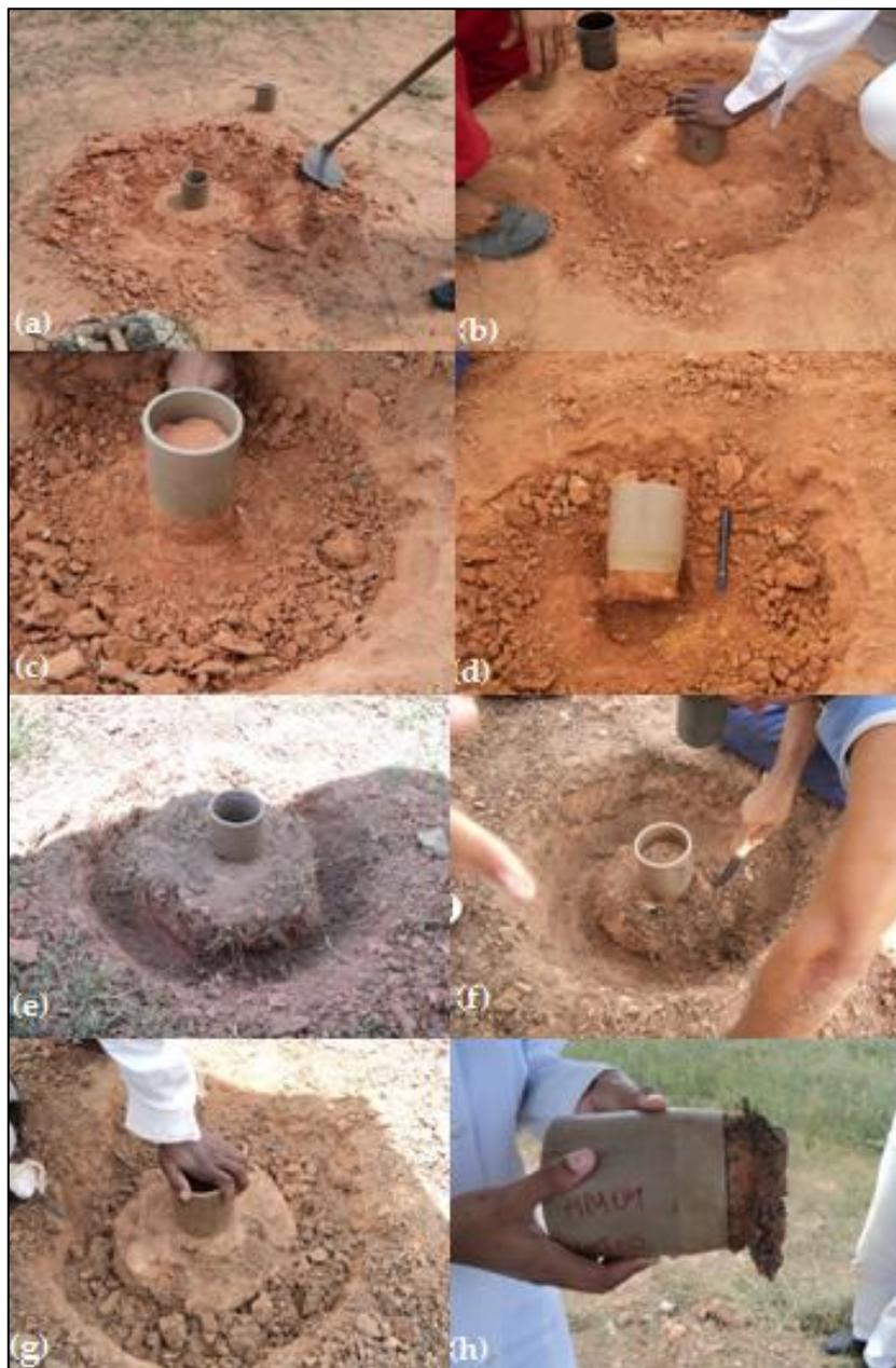
**Figura 43: Coleta de amostras para ensaio de permeabilidade (a) Limpeza do terreno (b) cravação (c) e (d) amostra da camada convencional (e) e (f) amostra da camada MET01 (g) e (h) amostra da camada MET02**
