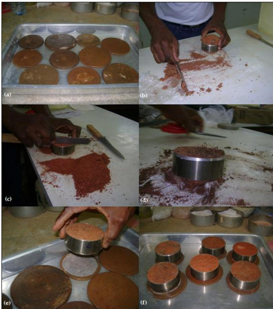
**Figura 41: Preparação dos corpos de prova para ensaio de curva de retenção: (a) pedras porosas para saturação por percolação (b) e (c) regularização do corpo de prova (d) corpo de prova MET01 (e) colocação dos corpos de prova para saturação por meio de percolação (f) saturação dos corpos de prova**
