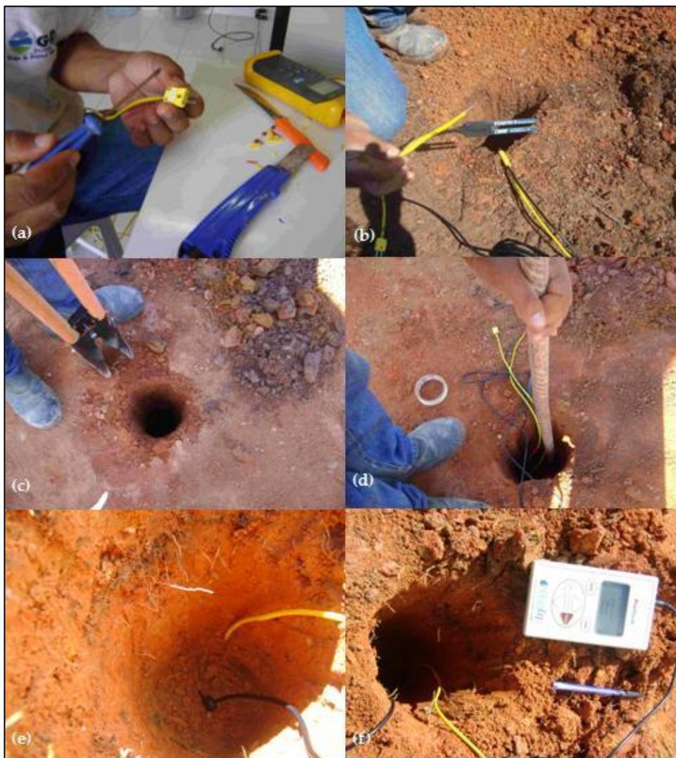
**Figura 58: Instrumentação para medidas de umidade e temperatura (a) conector tipo “k” (b) sensor de umidade e temperatura (c) escavação para instalação (d) recompactação da camada de cobertura (e) sensores inseridos no solo (f) testes de medição de umidade**
