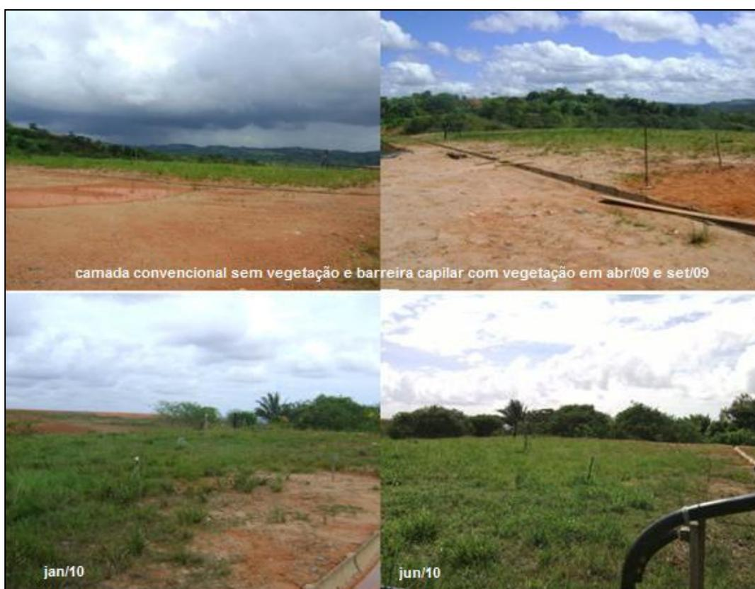
**Figura 92: Presença de vegetação na camada de cobertura tipo barreira capilar**
