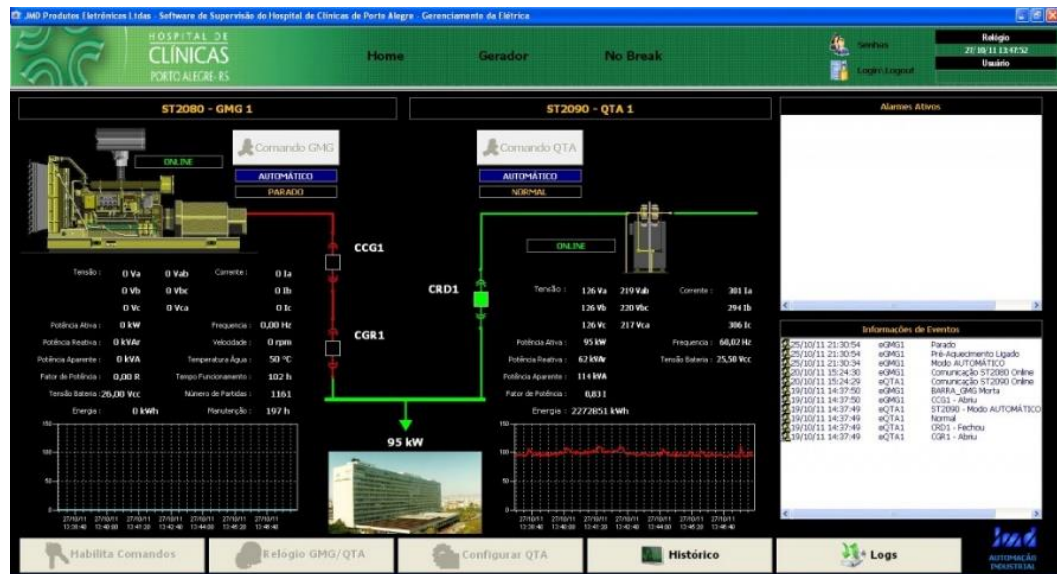
Figura 2 – Sistema supervisorio do HC de Porto Alegre: Monitoramento da Rede Elétrica
