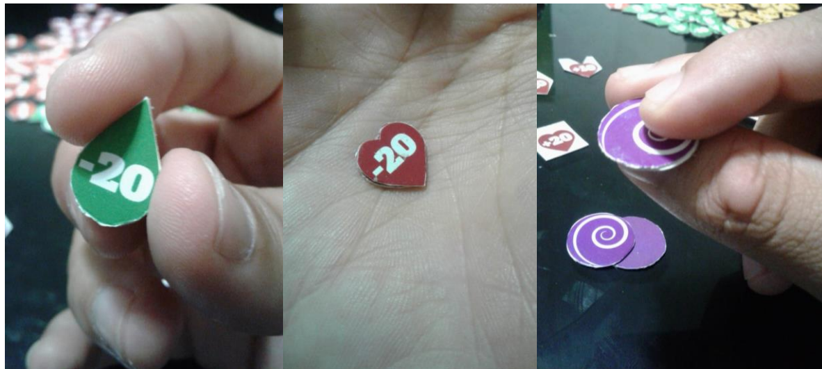
Figura 78 – Falhas de corte.
