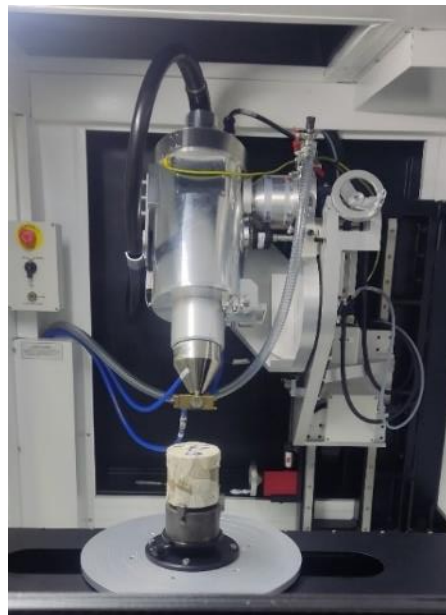
Figura 13: Posição do cilindro branco de pvc contendo a amostra de solo, dentro do tomógrafo de raio-X para escaneamento e obtenção das imagens.
