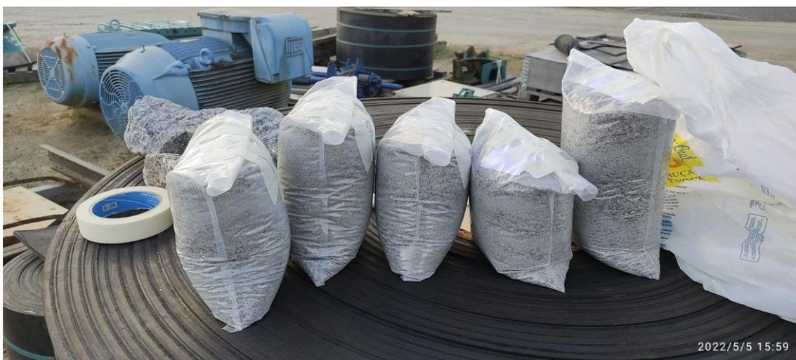
**Figura 9:** Alíquotas representativas de granito com aproximadamente 5 kg acomodada em sacos plásticos reforçados e amostras de rochas. **Fonte:** Acervo LMR-End
