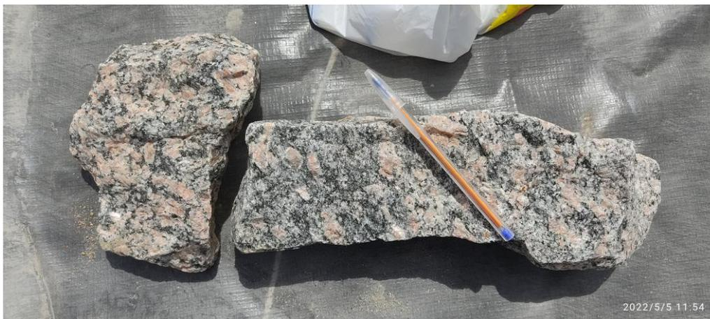
**Figura 6:** Amostra de Rocha coletada para laminação e descrição petrógrfica. **Fonte:** Acervo LMR-End
