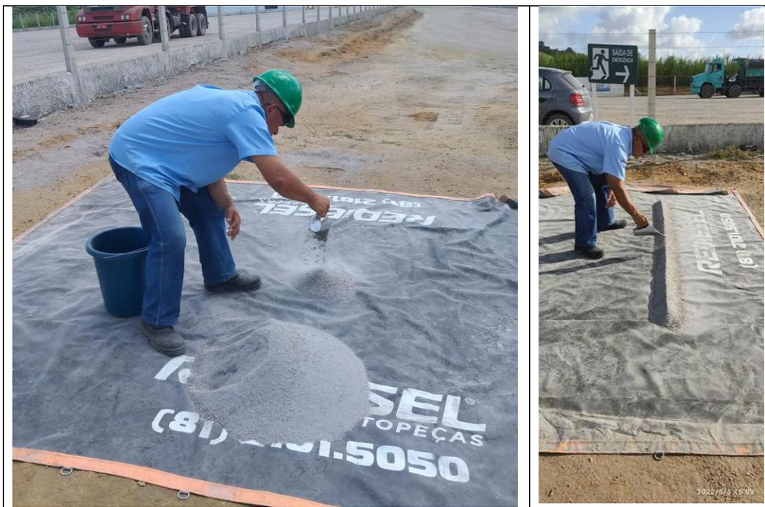
**Figura 8:** Pilhas de homogeneização de amostras produzidas com o granito <math><9,5\text{ mm}</math>: pilhas cônicas (a) e pilha alongada/triangular (b). **Fonte:** Acervo LMR-End
