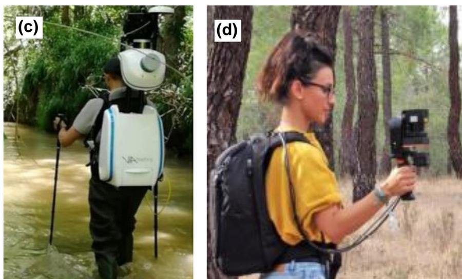
Figura 3. Tipos de suporte de varredura a laser terrestre: (a) tripé; (b) em veículo motorizado; (c) em mochila; (d) de mão. Fonte: (a) Adriana A. M. Nishiwaki (2022); (b) Aijazi et al. (2017); (c) Viametris.com; (d) Cabo et al. (2018).
