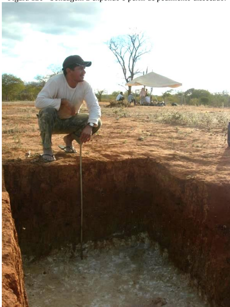
Figura 126 - Sondagem 2 expondo o perfil de pedimento dissecado.
