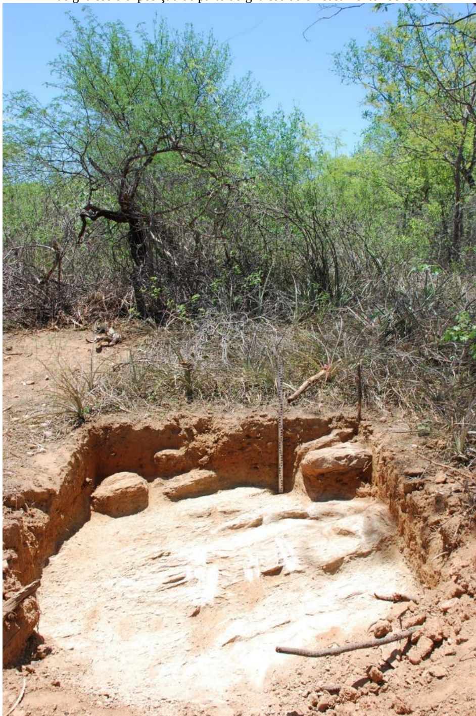
Figura 94 - Sondagem expondo os sedimentos alúvio-coluviais e/ou corrida de lama com a presença de clastos de gnaiss e exposição de parte do gnaiss do embasamento rochoso.
