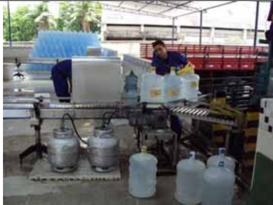
Foto 27- Saída dos Garrafões através de esteiras - Sistema automatizados
