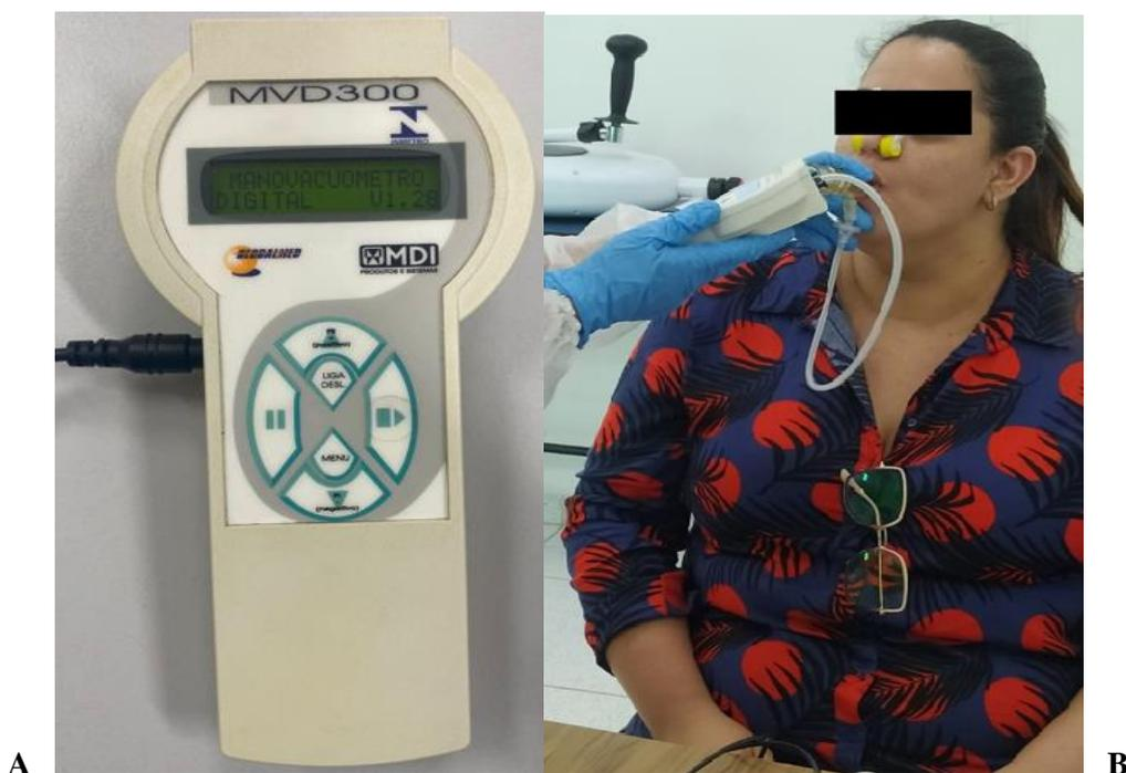
**Figura 1.** Manovacuômetro digital para medição da pressão muscular respiratória.
