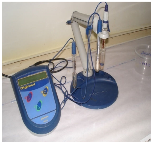
Figura 11. Medidor de pH utilizado para a aferição de pH das soluções.
