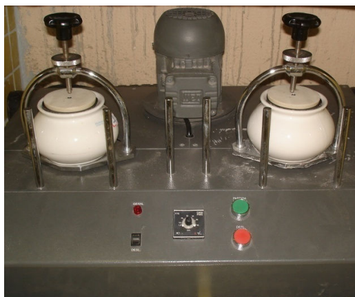
Figura 19. Moinho planetário utilizado para redução de tamanho do mineral de calcita.
