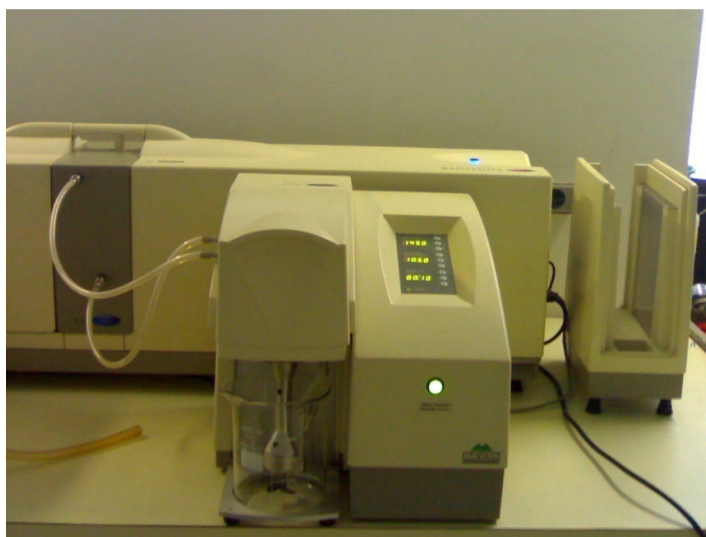
Figura 20. ATP- laser Malvern, modelo Master Sizer 2000 utilizado para caracterização da grafita e calcita.
