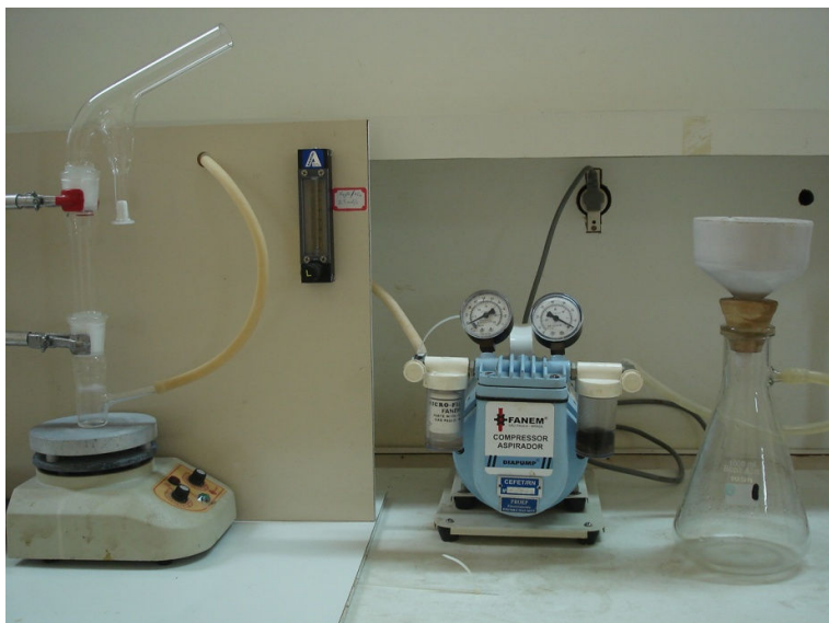
Figura 21. Aparato composto por Tubo de Hallimond, bomba de vácuo e kitazato empregado nos ensaios de flotação de grafita e calcita.
