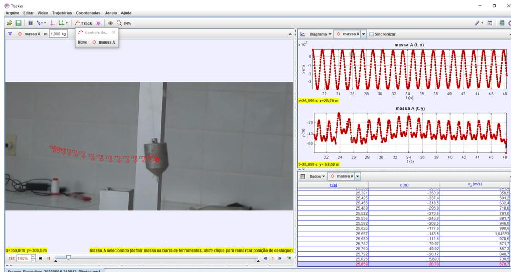
Figura 15 - Análise das oscilações no Tracker. Gráficos  $x(m)$  vs. tempo(s) e  $y(m)$  vs.  $t(s)$ .
