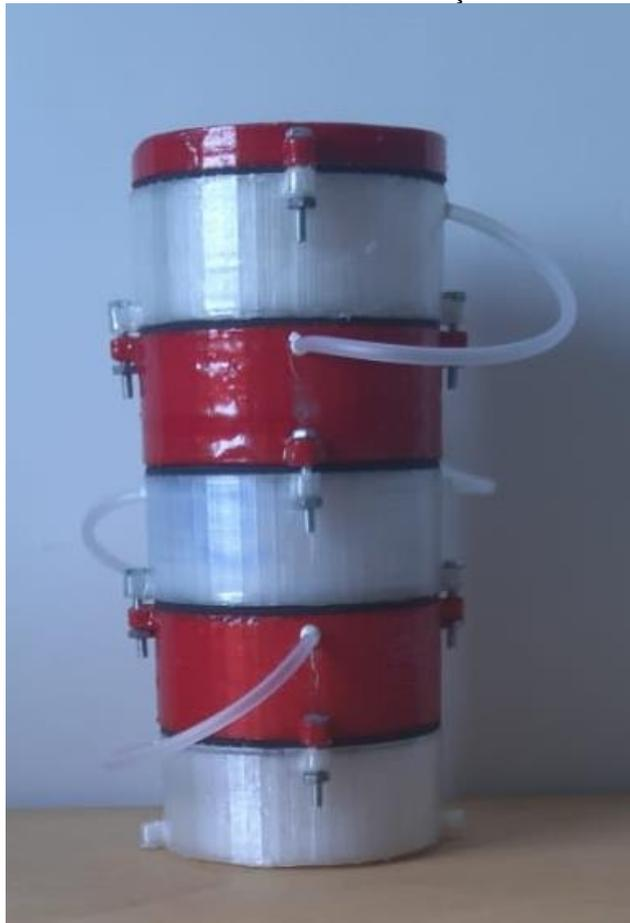
O pulmão do compressor, utilizado para unir as 4 saídas, é apresentado de modo impresso (Figura 19A) e de modo fixado e resinado (Figura 19B). Cada metade do pulmão obteve um tempo de produção na impressão 3D de 1 hora e 47 minutos.
