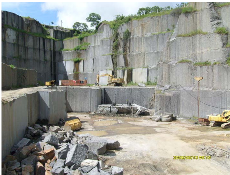
Foto 4 – Detalhe das frentes de lavra da Minérios de Bom Jardim. Observar as bancadas altas desenvolvidas ao longo de 6 níveis topográficos diferentes, com aproximadamente 6 m de altura. Notar a perfeita geometria dos cortes das bancadas abertas através de fio diamantado, uso de quarry-bar e demais equipamentos de lavra: retro-escavadeira, compressores, marteletes, guindaste Derrick e caminhões basculantes.
