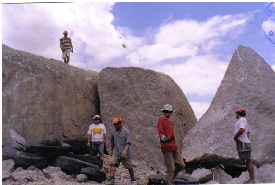
Foto 27 – Matacões cortados para desdobramento em blocos. O fragmento irregular no lado direito, indica que houve falha na identificação do plano natural de corte e possivelmente na direção da raição do furo.
