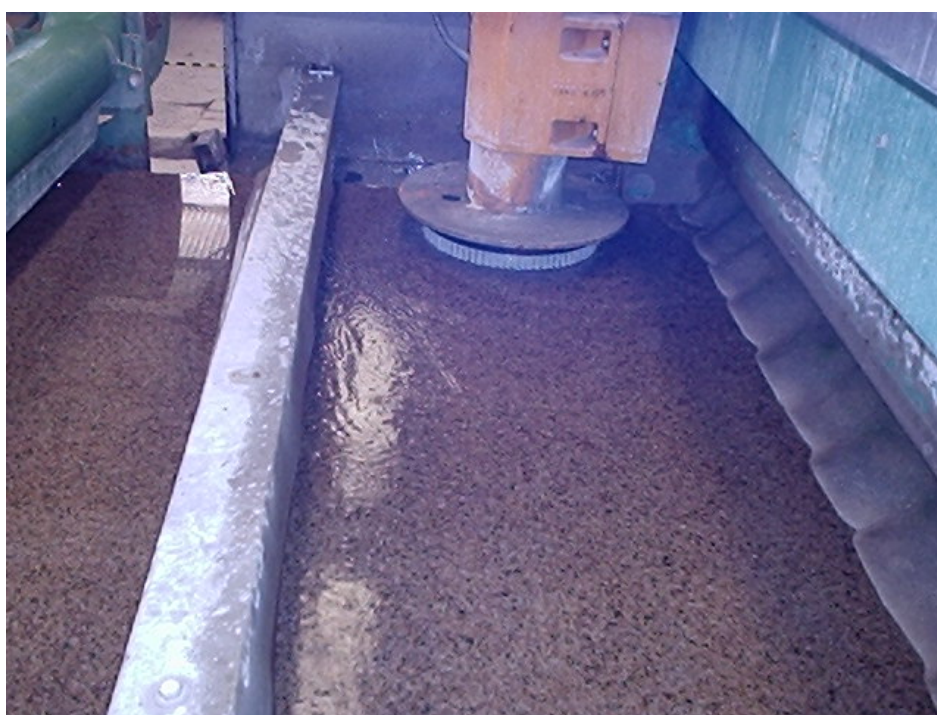
Foto 34 – Etapa do processo de beneficiamento, onde as chapas de granito são polidas, apresentando no final uma superfície lisa e opaca.
