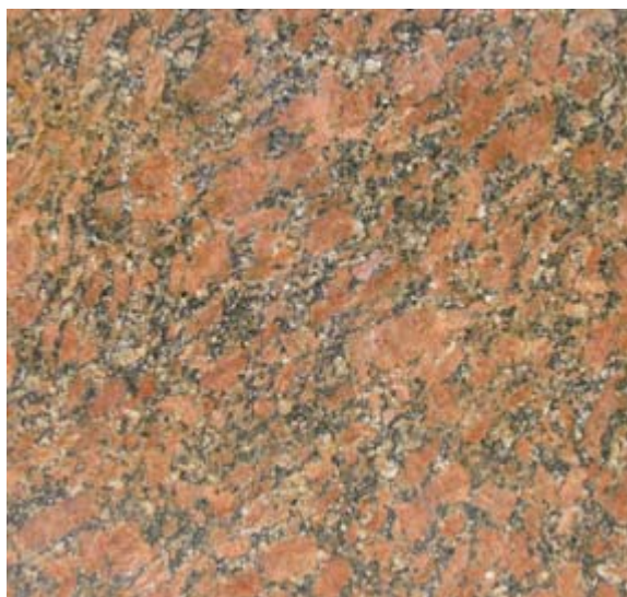
Foto 13 – Placa polida do granito Vermelho Ventura. Os pórfiros vermelhos são de microclina e as concentrações escuras são de máficos, especialmente a biotita.
