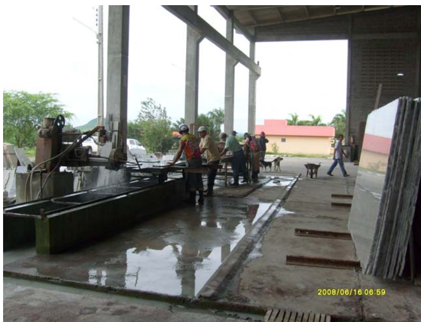
Foto 36 - Seção de corte e acabamento das chapas de granito -PERGRAN
