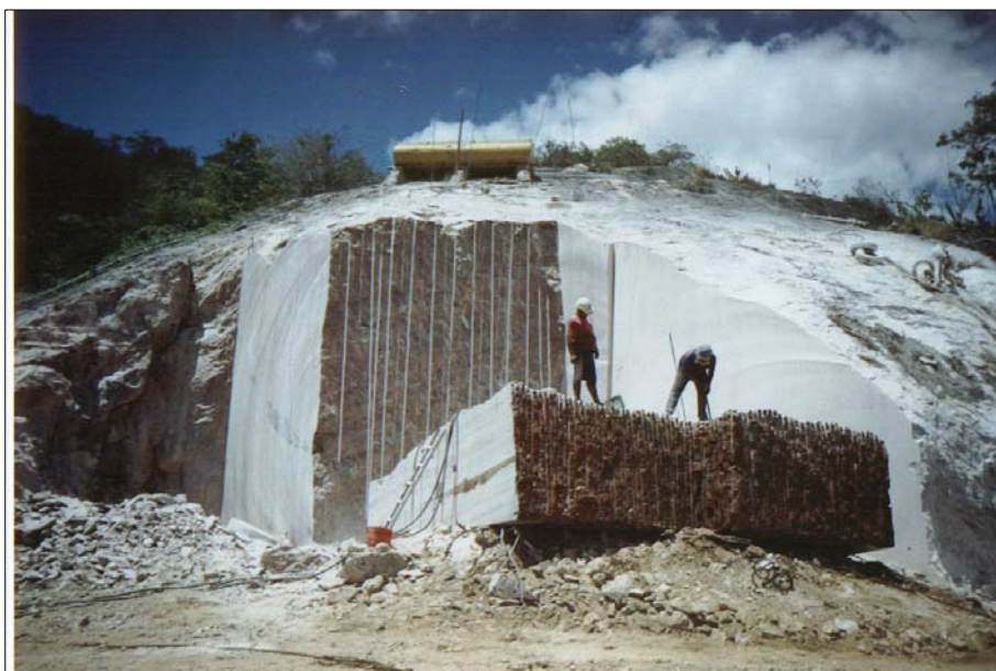
Foto 12 – Pedreira da Mineração de Granitos do Brasil Ltda. Vista de um corte vertical em uma bancada com uso de fio diamantado e emprego de argamassa expansiva no desmonte de uma prancha. Local : Bacoré (Arcoverde).
