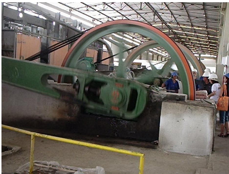
Foto 31 - Conjunto de teares Giardini Maggio, utilizados nos desdobramentos dos blocos de granitos (GRANEX - SUAPE)
