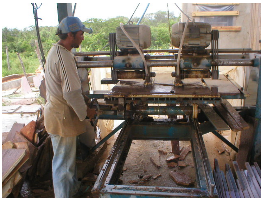
Foto 23 – Serraria de quartzito. Corte em placas padronizadas, Poço do Curral (Santa Cruz) .
