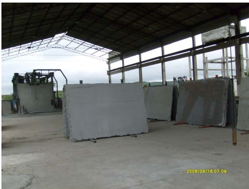
Foto 38 – Chapas de granitos desdobrados antes de iniciar o processo de polimento – Serraria Global Mármore e Granitos do Brasil
