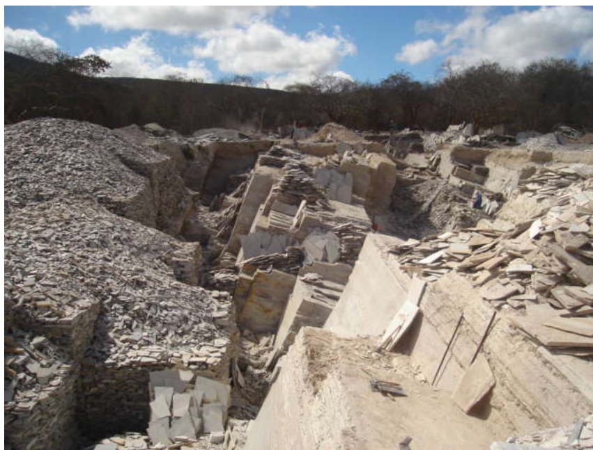
Foto 22 – Pedreira de quartzito de Santa Cruz. Observar o mergulho da rocha, tamanho das placas destinadas à fabricação de ladrilhos e a grande quantidade de pedaços irregulares (cacos).
