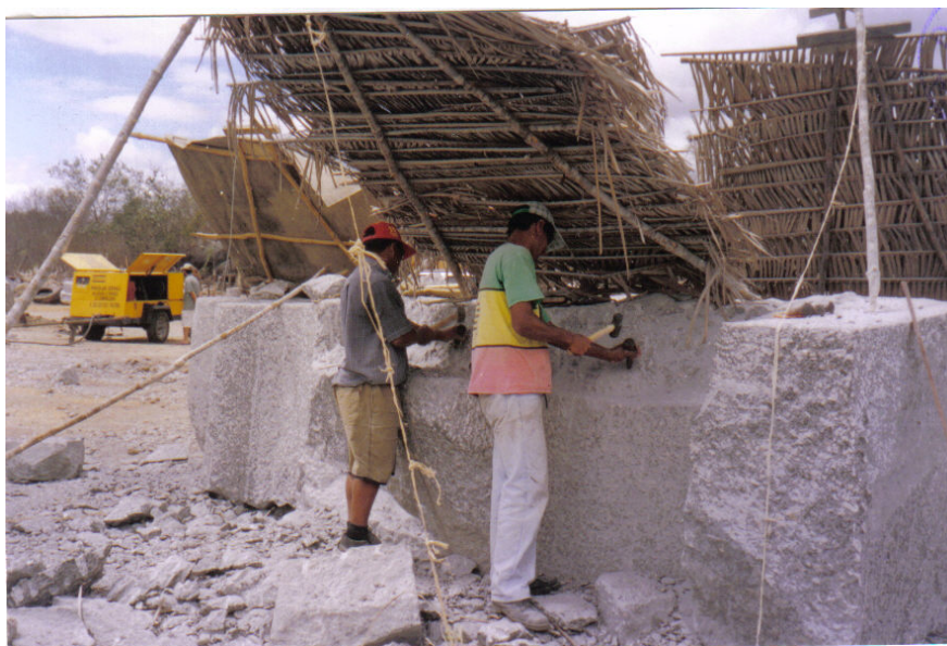
Foto 25- Artesãos desbastando um bloco extraído de matacão. O trabalho de escultura é extremamente lento em função do método utilizado. O desmonte utilizando massa expansiva pode acelerar o processo.
