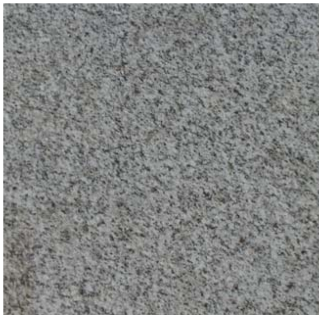
Foto 21 – Placa polida do granito Cinza - Prata. Verificar que se trata de uma rocha homogênea, de cor cinza-clara, cuja orientação é dada por palhetas prateadas de muscovita
