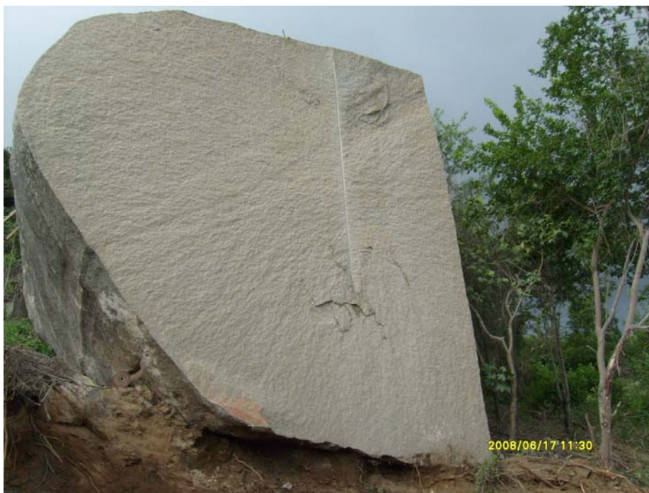
Foto 6 : Bloco do granito Amarelo Ipanema. Observar o detalhe do corte feito com um único furo raiado nas direções preferenciais de partição da rocha.
