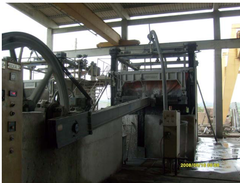
Foto 35 – Tear utilizado para o desdobramento dos blocos de granitos - PERGRAN
