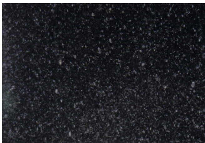
Foto 20 – Placa polida do granito Preto Pernambuco. Notar manchas de tonalidade branca e/ou preta, que contrastam com a cor cinza-grafite.
