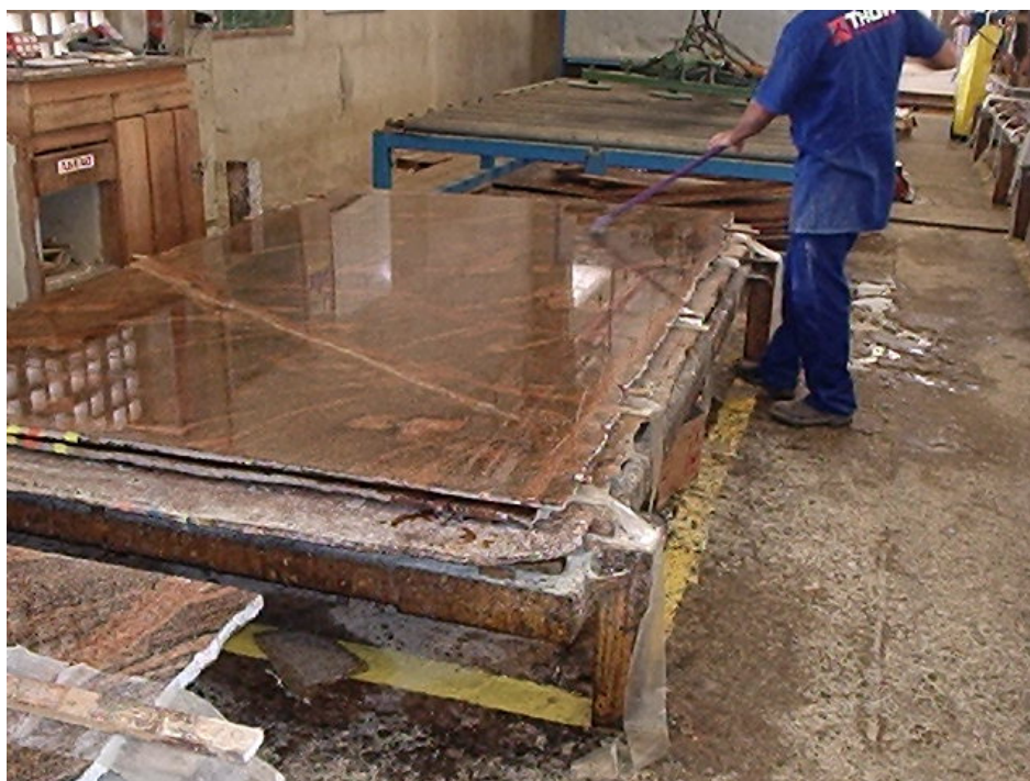
Foto 33 –Placa de granito no processo de resinagem
