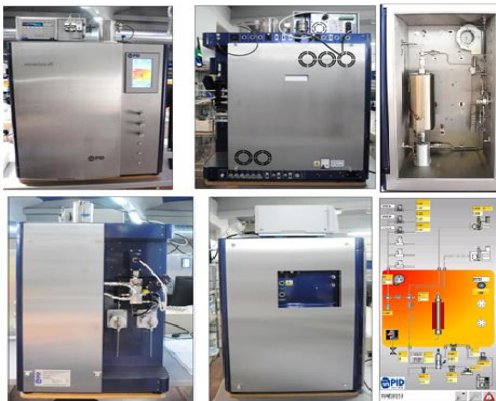
Figura 14 - Detalhes da unidade MICROACTIVITY-effi da Eng&Tech.
