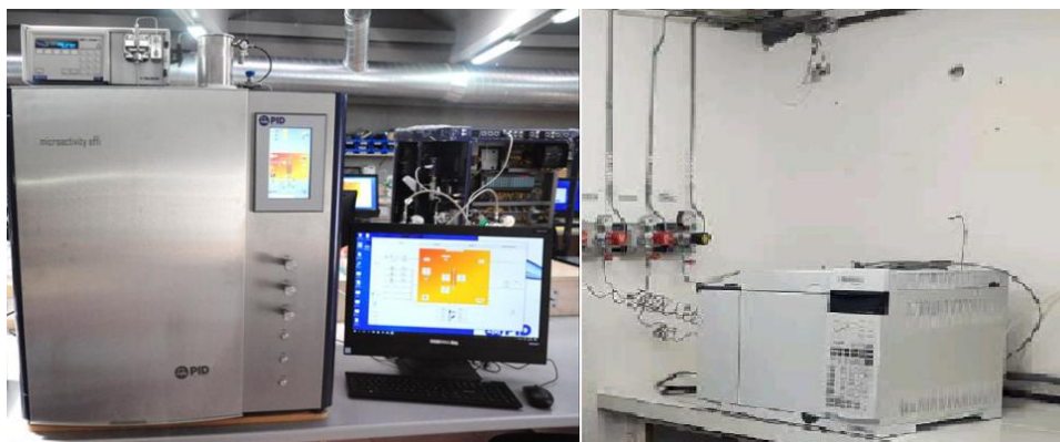
Figura 13 - Unidade PID MICROACTIVITY-effi, conectada ao cromatógrafo.
