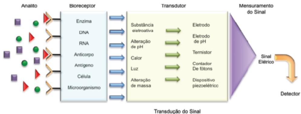
**Figura 5.** Componentes do biossensor. Adaptado de (102).
