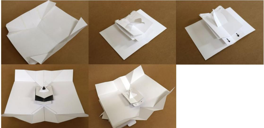
Diferente dos outros mecanismos aqui produzidos, algumas peças deste não foram unidas por meio de cola, mas sim através do encaixe de abas em fendas (*slots*) de outras peças. O processo de ajustar as angulações e as proporções quanto ao encaixe das peças entre si demandou a maior parcela de tempo nessas experimentações, já que até mesmo a variação de gramaturas do papel, por exemplo, geraram alterações/dificuldades na montagem.
