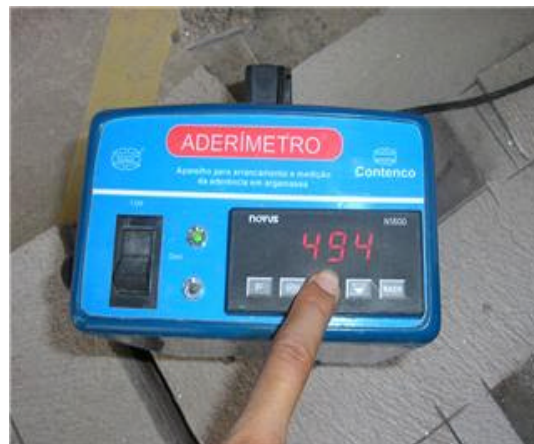
Figura 46 - Leitura do aderímetro no momento da ruptura - (autor, 2007)
