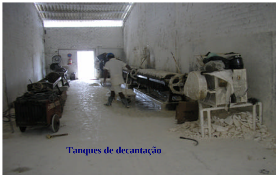
Figura 20 (B) – Ilustração dos Tanques de decantação da unidade de beneficiamento de caulim nas Empresas de Mineração nos Estados da Paraíba PB e no Rio Grande do Norte RN.
