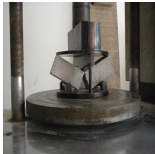
Figura 34 – Detalhe da ruptura do Ensaio de tração por flexão (autor, 2007)
