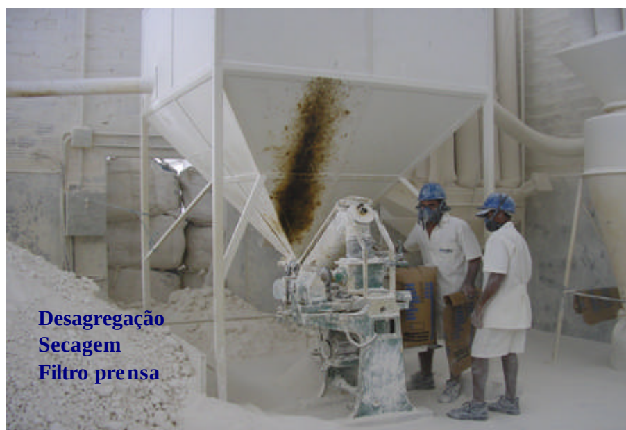
Figura 20 (C) – Ilustração do Produto final, desagregação, secagem e filtro prensam da unidade de beneficiamento de caulim nas Empresas de Mineração nos Estados da Paraíba PB e no Rio Grande do Norte RN.
