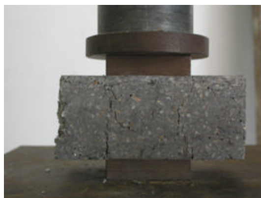
Figura 37 - Detalhe de fissuras quando do rompimento de corpo de prova( autor, 2007)
