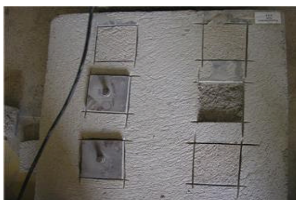
Figura 44 – Molde já ensaiado, quando se observa o substrato após extração. (autor, 2007)
