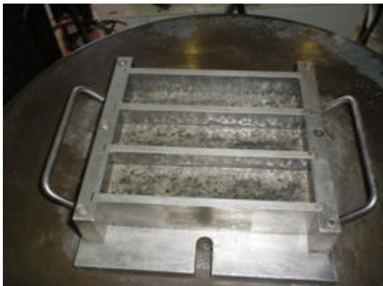
Figura 29 - Molde de corpo de prova para Ensaio de resistência à flexão (autor, 2007)
