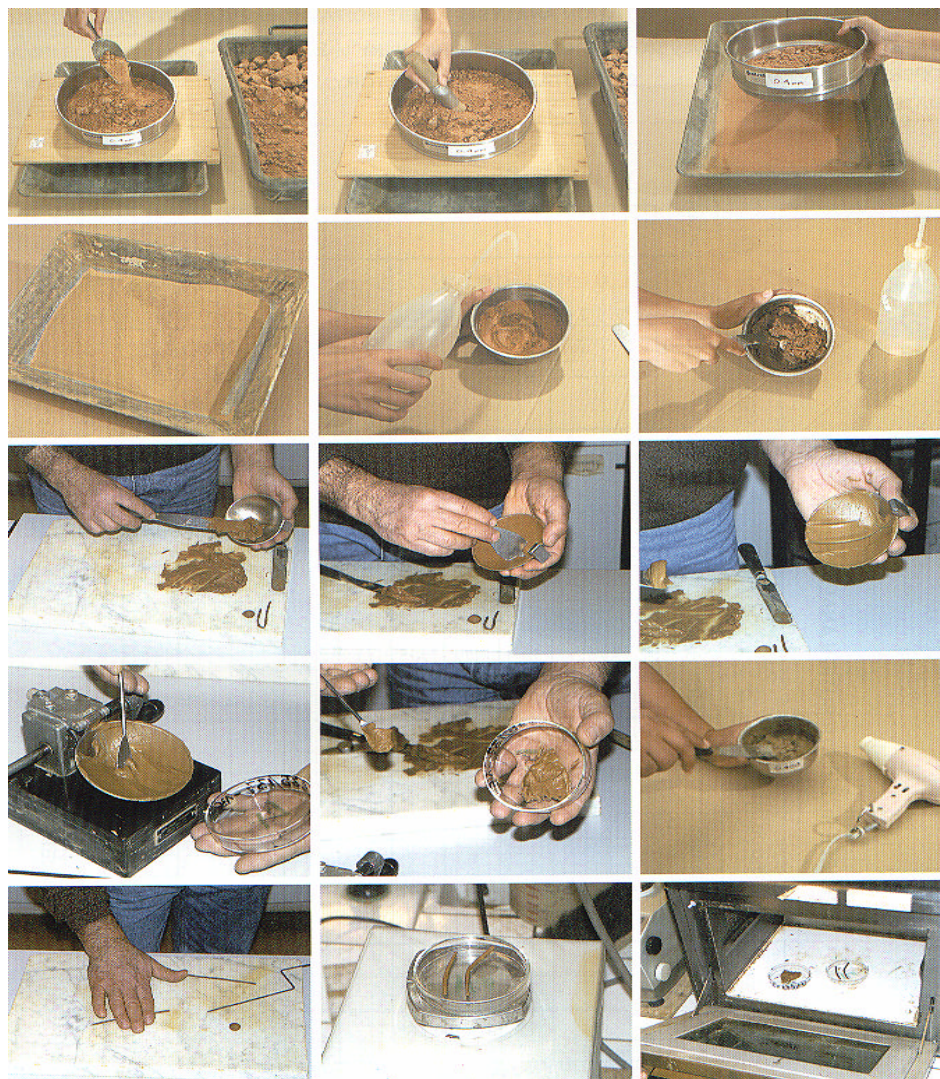
Figura 9 – Seqüência de execução dos ensaios dos Índices de Atterberg. Limite de liquidez e plasticidade , (Lira, 2007)
