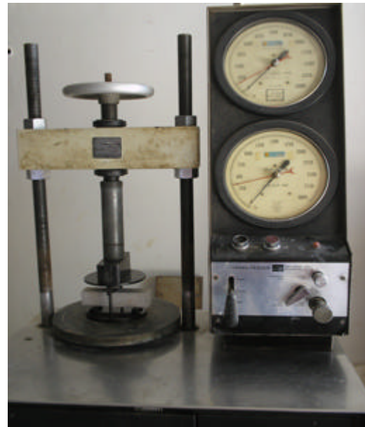
Figura 32 – ensaio de tração por flexão (autor, 2007)
