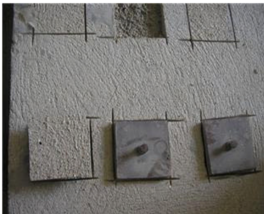
Figura 45 - Rompimento das placas durante o ensaio - (autor, 2007)
