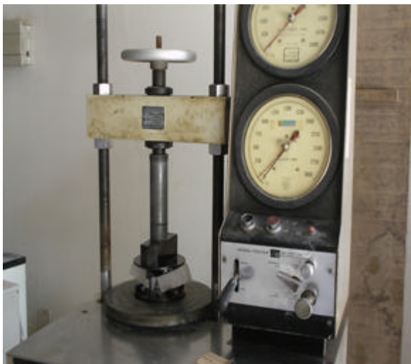
Figura 33 – Detalhe de ensaio de tração por Flexão (autor, 2007).
