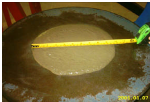
Figura 26 - Ensaio de consistência na mesa de fluidez (Oliveira, 2004)
