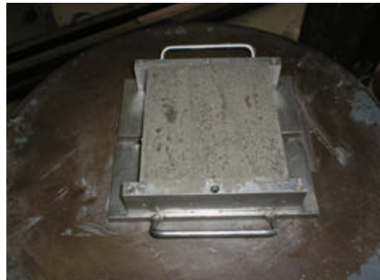
Figura 30- Confecção de corpos de prova ainda no estado fresco (autor, 2007).
