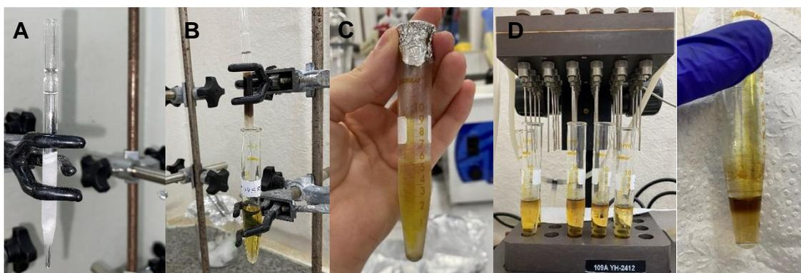
Figura 5. Purificação dos extratos de óleo: (A) coluna cromatográfica de adsorção montada em uma pipeta Pasteur com fibra de vidro, sílica gel (5% desativada) e sulfato de sódio; (B) eluição do extrato para purificação; (C) extrato purificado; (D) concentração do extrato purificado no evaporador em fluxo de nitrogênio; (E) extrato do óleo purificado e concentrado a 1 mL.
