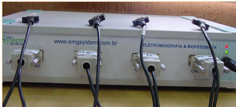
**Figura 8:** Módulo Condicionador de Sinais.
