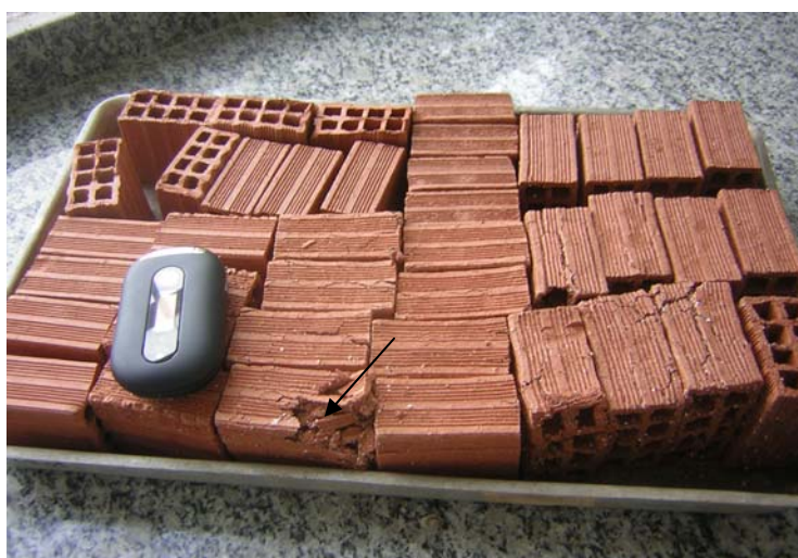
Figura 4.8 – Falência estrutural dos tijolos.
