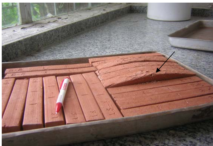
Figura 4.7 – Falência estrutural das barras.
