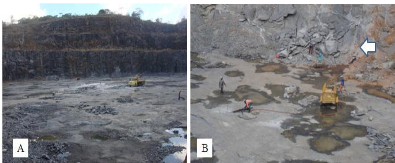
Fig.8 (A) Vista panorâmica da frente da lavra de brita; (B) Detalhe de rachões e paralelos formando fragmentos de diversos tamanhos para a exploração da rocha.
