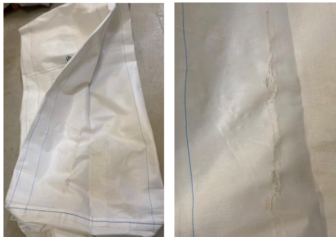
Figura 08 – Coletor de big bag com estrutura rasgada
