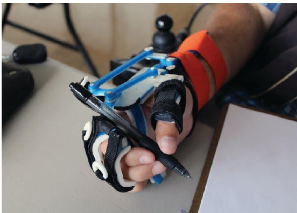
Figura 14 – Qualidade e funcionalidade de órteses através da sua fabricação na tecnologia FFF
