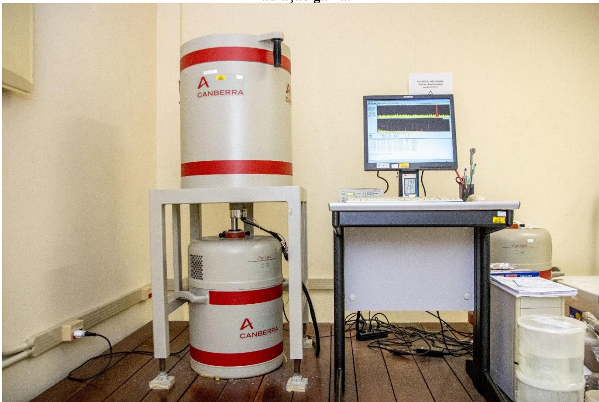
Figura 21 - Sistema EGAR com detector HPGe utilizado para realizar os ensaios de atenuação de radiação gama.
