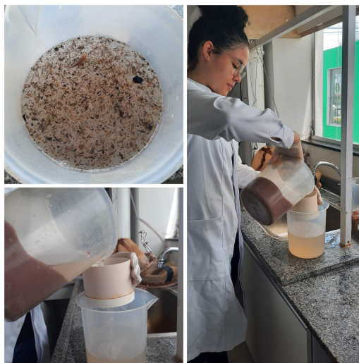
Figura 8 - Método de flotação com solução saturada de NaCl
