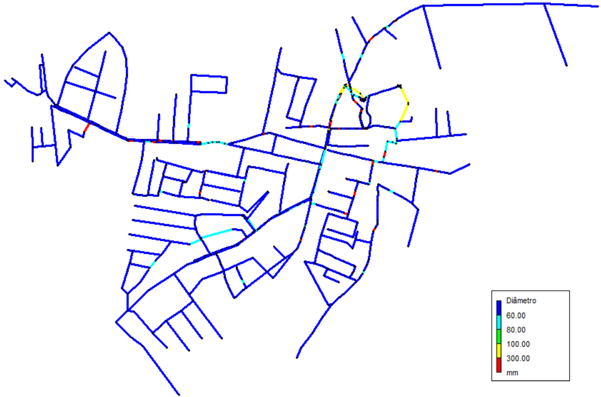
Figura 33 – Diâmetros otimizados da Rede Panelas determinados pelo H-PSOTS
