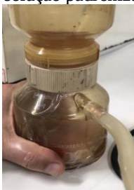
Figura 6: Esterilização por filtração da solução padronizada de Hymenaea stigonocarpa Mart. Ex
