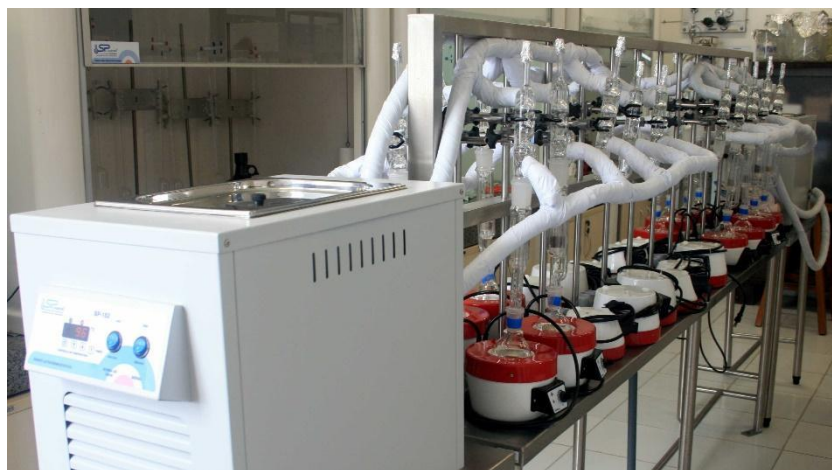
Figura 13. Aparato Soxhlet usado para extração de hidrocarbonetos das amostras de sedimento.
