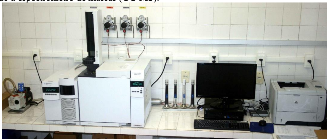
Figura 15. Cromatógrafo a gás equipado com detector de ionização de chama (GC-FID) e acoplado a espectrômetro de massas (GC-MS).
