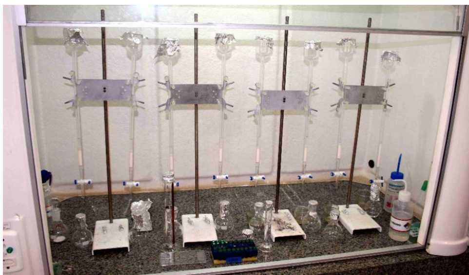
Figura 14. Colunas cromatográficas usadas para a purificação e separação dos extratos orgânicos.
