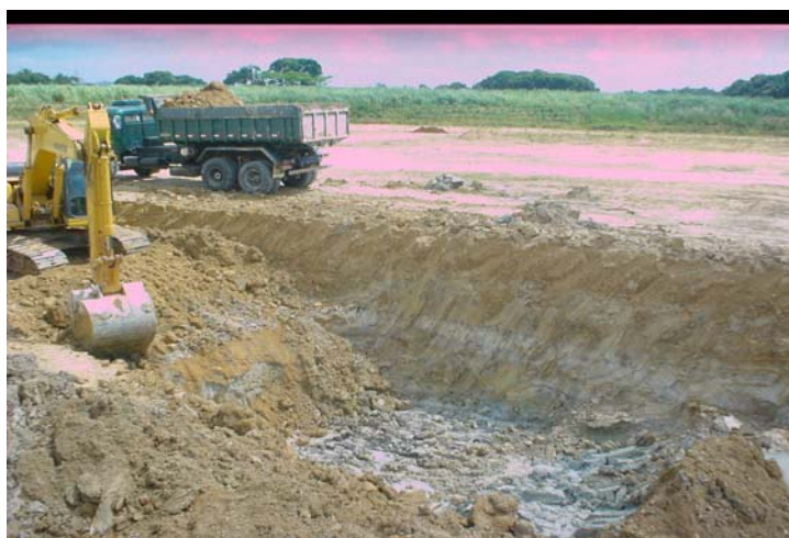
Fig. 3.4 – Método de Lavra em tiras (“STRIPPING MINING”).
