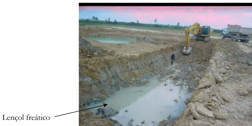
Fig. 3.3 – Método de Lavra em tiras (“STRIPPING MINING”).
