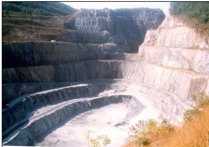
Fig. 2.1 – Método de Lavra “ open pit mining ”.
