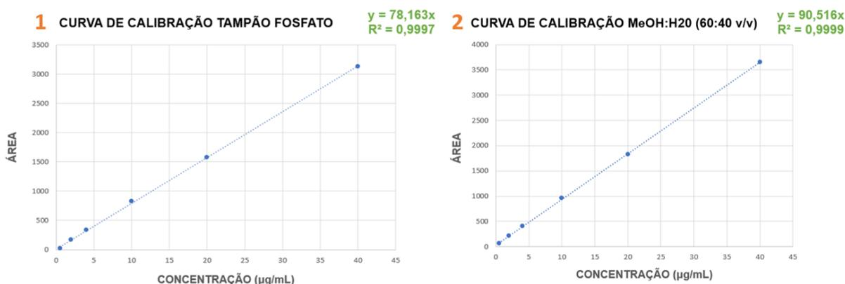
**Figura 13.** Curva analítica da cafeína em (1) tampão fosfato 0,1 M e (2) Metanol e água (60:40 v/v), obtida por cromatografia líquida de alta eficiência. Fonte: Autoria própria.
