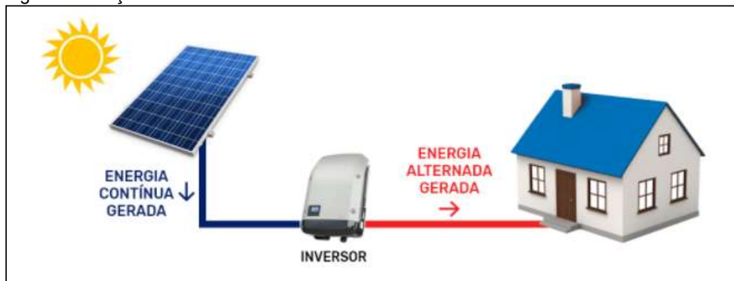
Figura 2- Função do inversor
