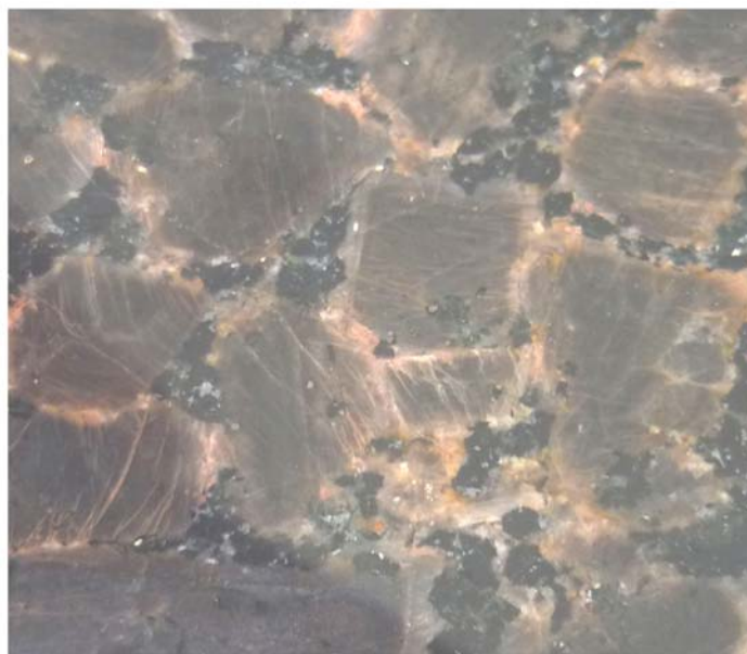
ENSAIO OXIDABILIDADE POR CHOQUE TÉRMICO MARROM IMPERIAL FÁCIES 3
