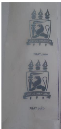
Figura 20 - Filmes de PBAT produzidos através da técnica de extrusão. (a) – PBAT puro; (b) – PBATOME1%; (c) – PBATOME5%
