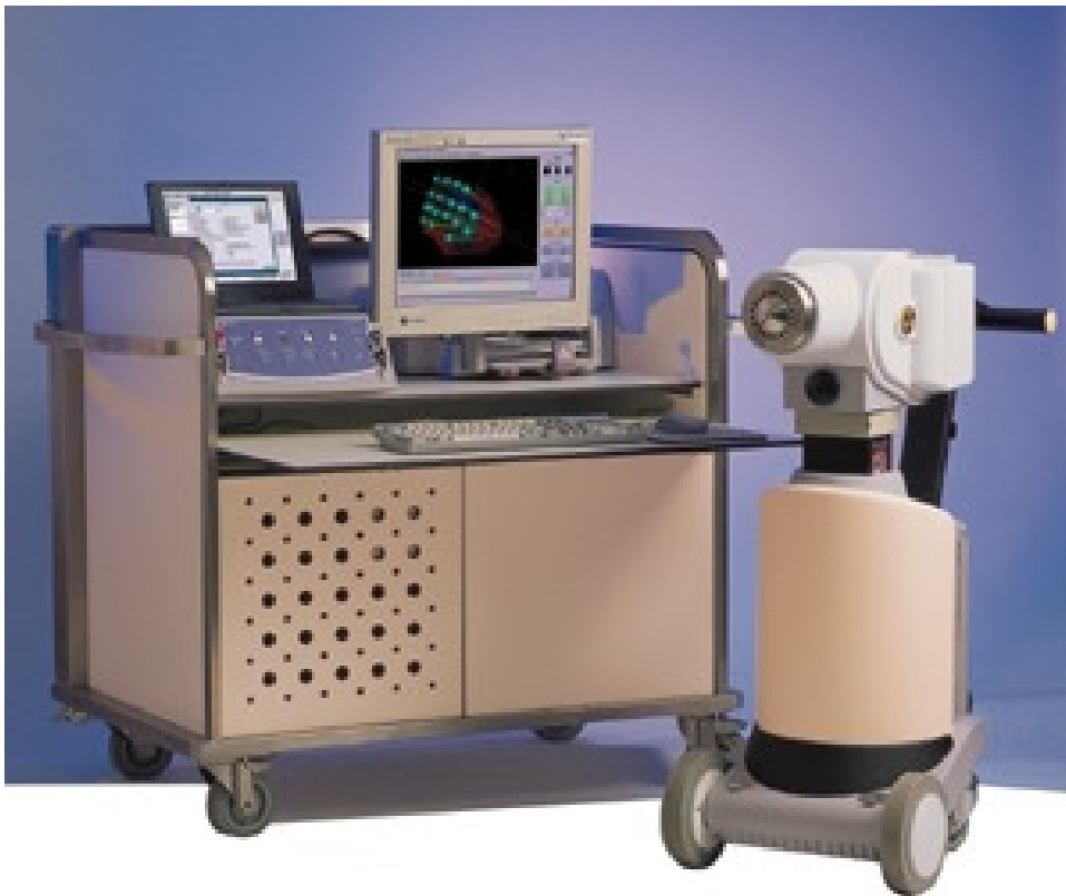
Figura 2: Equipamento de braquiterapia de alta taxa de dose. A esquerda está o sistema de planejamento e à direita está a unidade remota que armazena uma fonte de ^{192}\text{Ir} .
