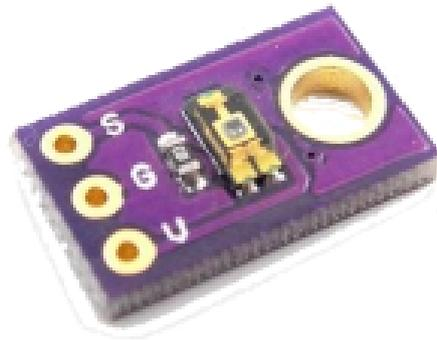
Figura 2.6: Sensor TEMT6000. Fonte: Auto Core Robotica
