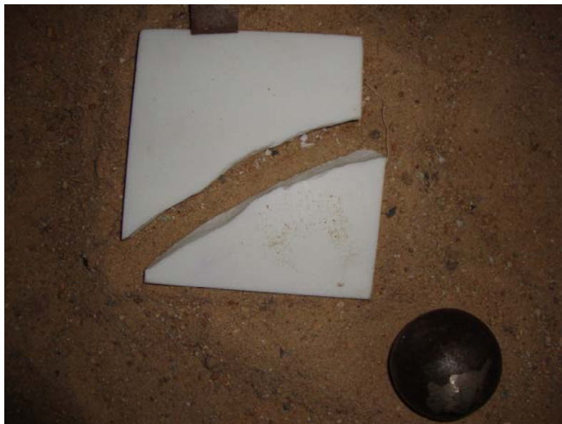
Figura 34: Ruptura de corpo de prova no equipamento de impacto de corpo duro disponível no Laboratório de Rochas Ornamentais do Departamento de Engenharia de Minas da UFPE.
