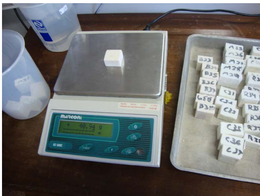
Figura 30: Pesagem a seco de corpo de prova para determinação dos índices físicos do marmoglass.
