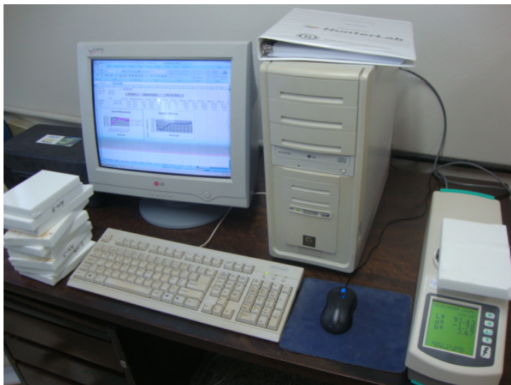
Figura 35: Equipamento de medição de cor utilizado para ensaios de alterabilidade acelerada do Laboratório de Rochas Ornamentais do DEMINAS/UFPE.
