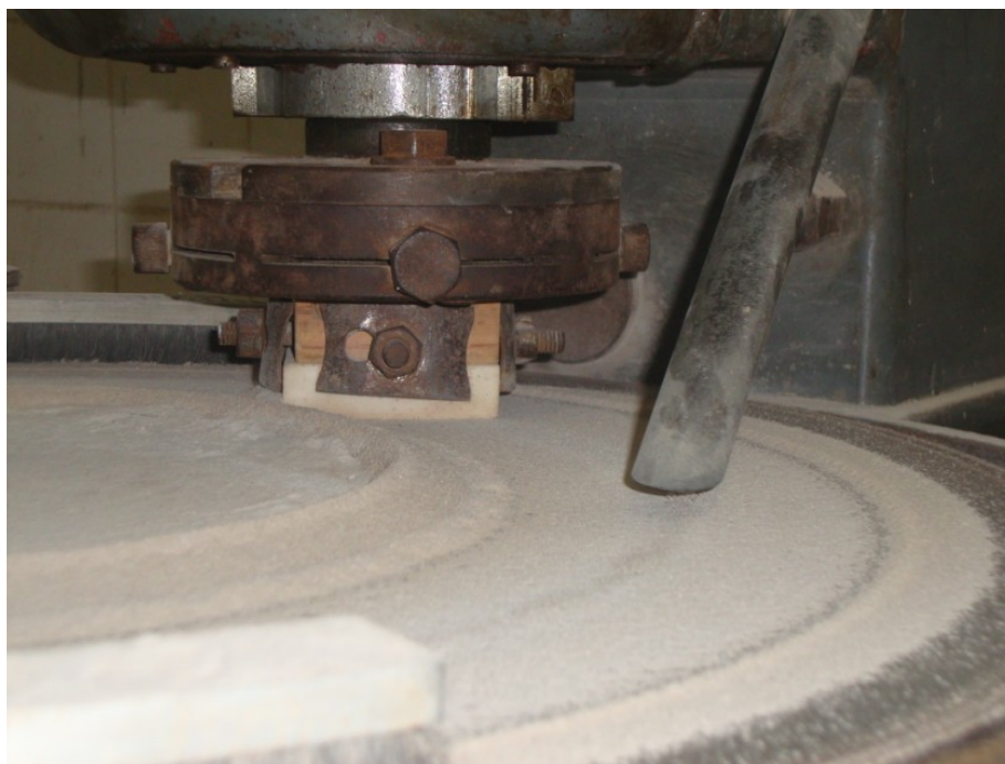
Figura 33: Equipamento para execução do ensaio de resistência ao desgaste abrasivo tipo Amsler.
