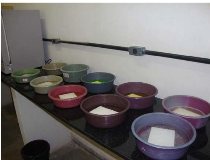
Figura 36: Amostras de marmoglass imersas em reagentes químicos para ensaios de alterabilidade acelerada.
