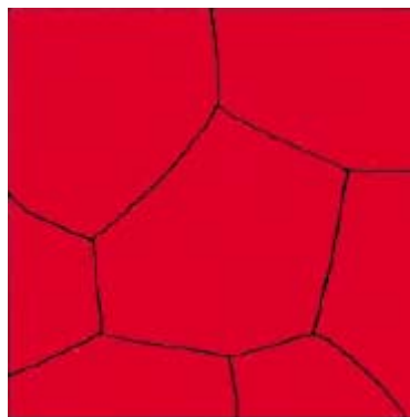
Figura 6 – Adensamento do vidro a 850°C
