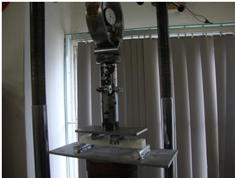
Figura 31: Equipamento utilizado para execução dos ensaios de resistência à flexão (Laboratório de Mecânica de Solos e instrumentação – DECIV/UFPE).
