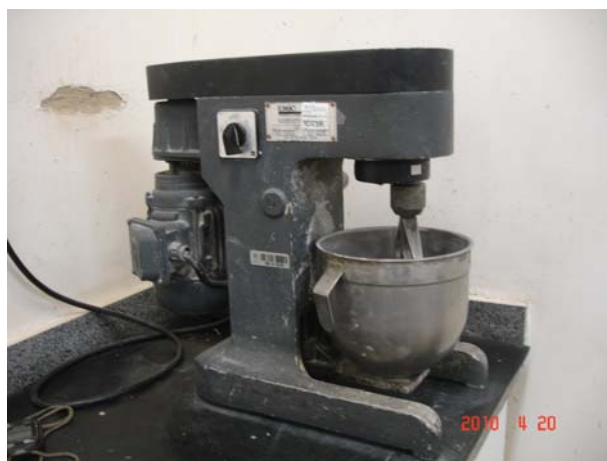
Figura 2.6 - Misturador utilizado na confecção das argamassas.
