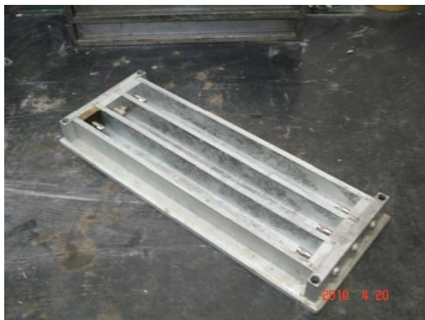
Figura 2.7 - Molde utilizado na confecção das barras de argamassa.
