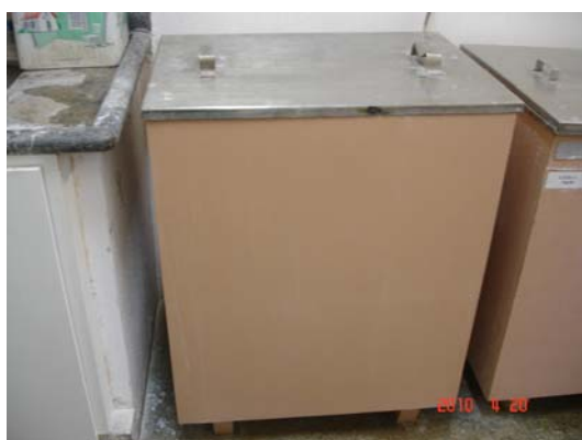
Figura 2.8 - Vistas externa e interna do recipiente para imersão das barras em água destilada.
