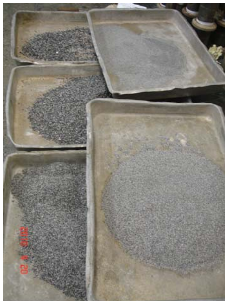
Figura 2.5 – Amostra de agregado após o peneiramento e secagem em estufa.
