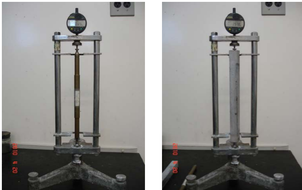
Figura 2.9 - Relógio comparador com barra-padrão e com barra de argamassa pronta para leitura.
