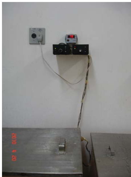
Figura 2.11 - Regulador de temperatura dos recipientes de imersão das barras.
