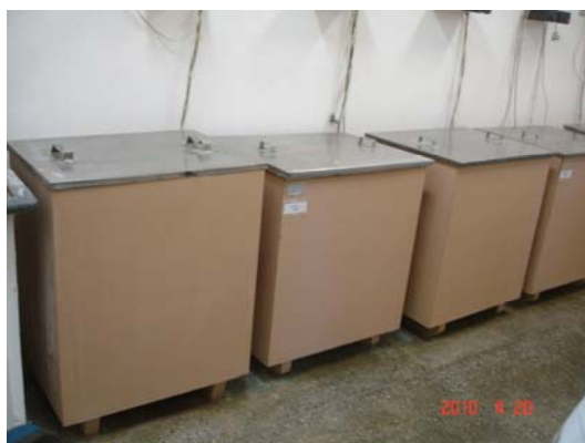
Figura 2.10 – Vistas externa e interna dos recipientes para imersão das barras em solução de NaOH.
