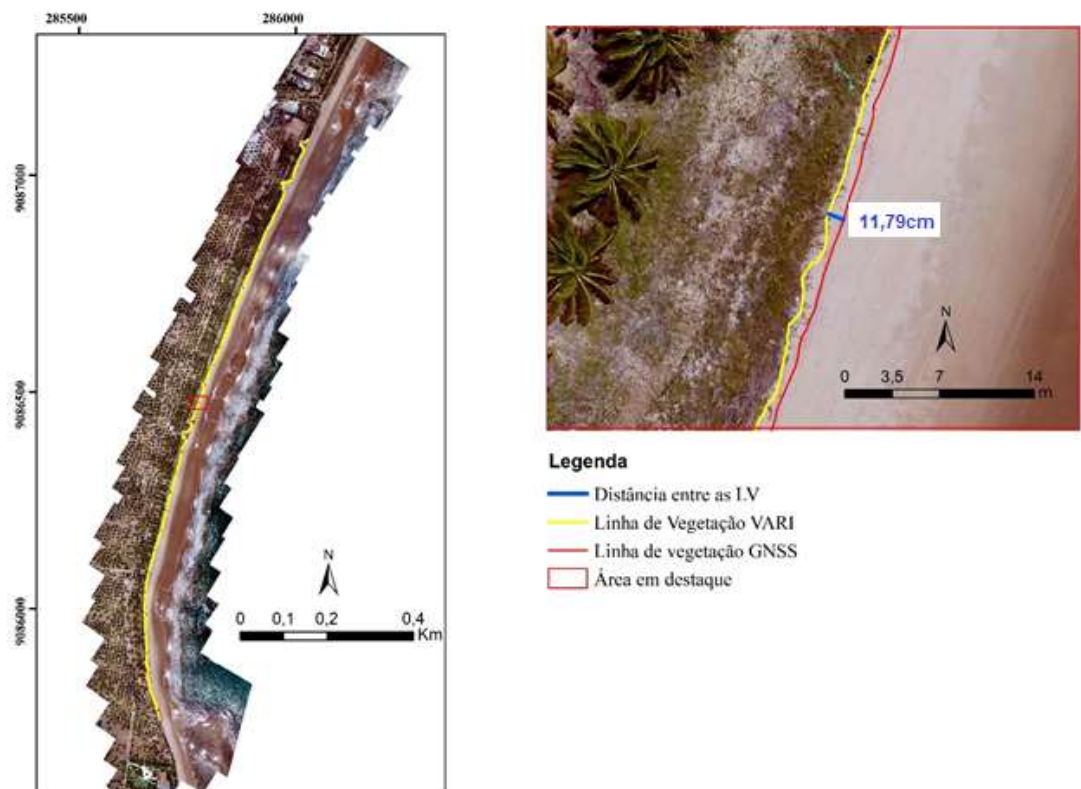
Figura 5 - Comparação entre a linha de vegetação identificada através do GNSS e a linha de vegetação identificada através do VARI.
