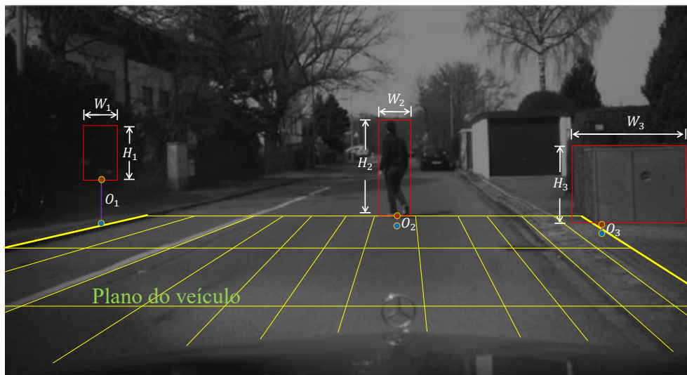
Figura 14 – Demonstração dos dados de largura, altura e deslocamento vertical de cada bounding box no espaço de coordenadas do veículo e o plano do veículo.
