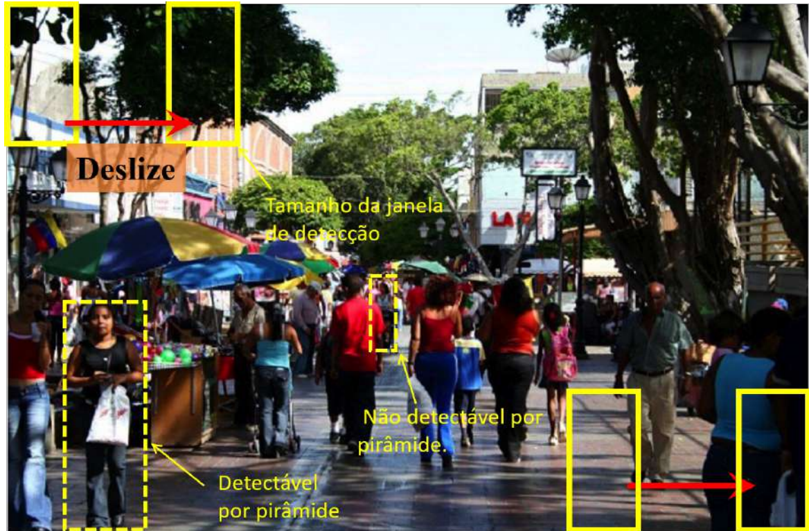
Figura 35 – Demonstração da dificuldade da abordagem de janelas deslizantes de única dimensão. Pedestres menores que a janela de detecção tendem a não ser detectados.
