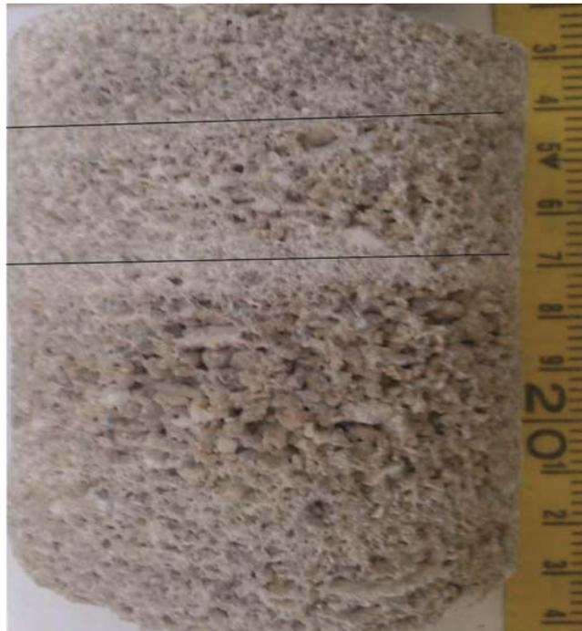
Figura 12: Amostra encontrada na litofácia 2 indicando estrutura laminar de baixo ângulo e presença de seixos.
