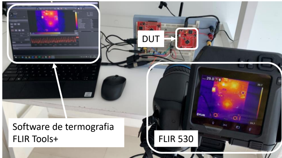
Figura 56 – Sistema de aquisição de dados infravermelho com uma câmera FLIR T530
