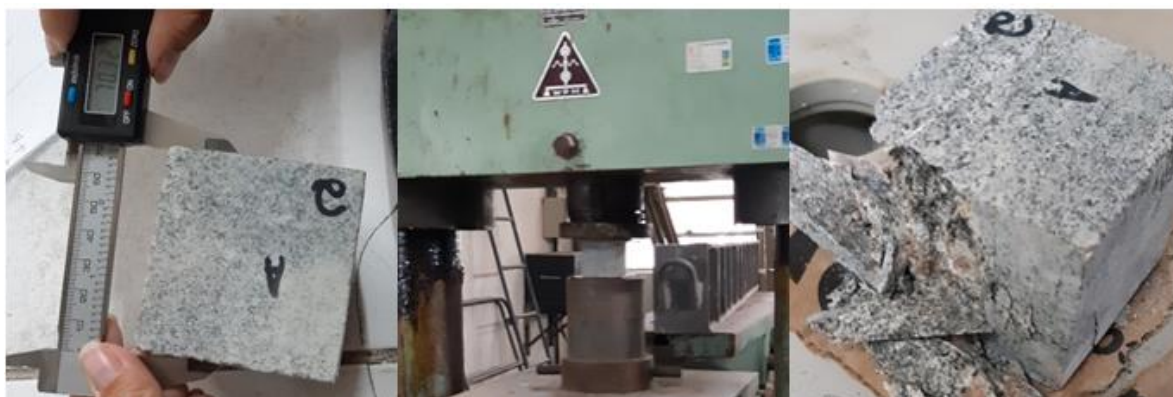
Figura 6 - Ensaios de compressão uniaxial realizados na UFPE
