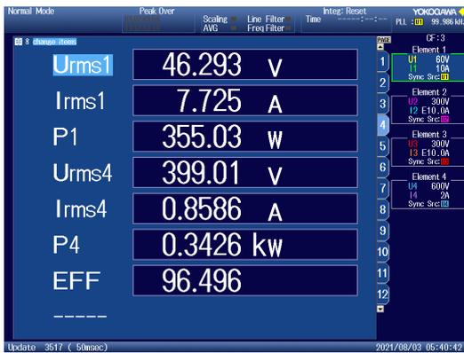
C.2 Diferentes ciclos de trabalho com  $V_{out} = 400\text{ V}$  e  $P_{out} = 350\text{ W}$ .
