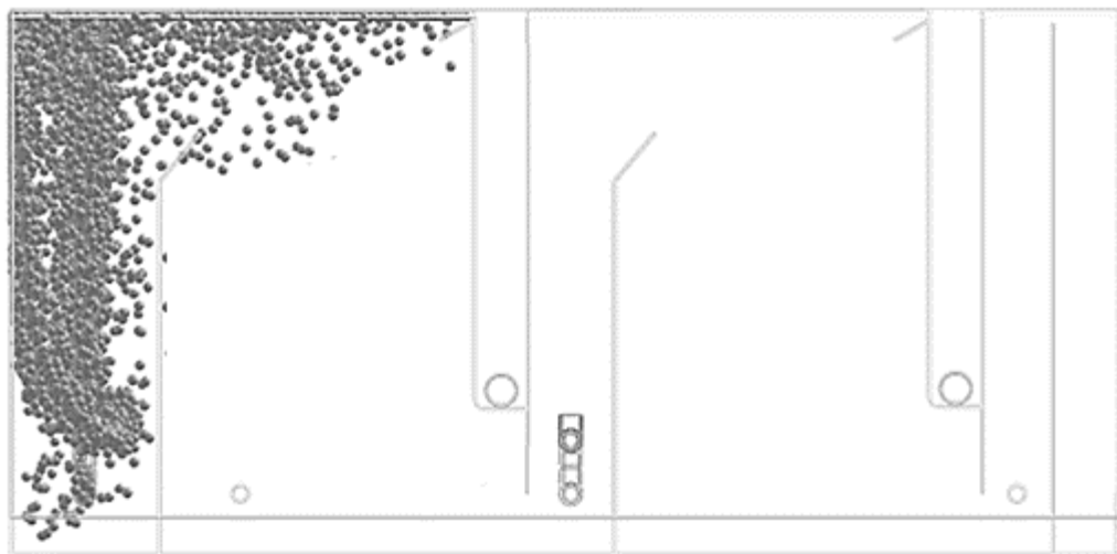
Figura 37 - Perfil fluidodinâmico do plano XY para agregados de 50 \mu\text{m} na configuração C3
