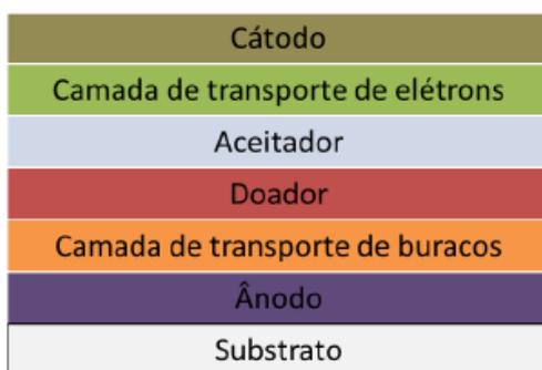
Figura 15. Esquema de uma OPV de heterojunção planar (fonte: SAMPAIO, 2022).
