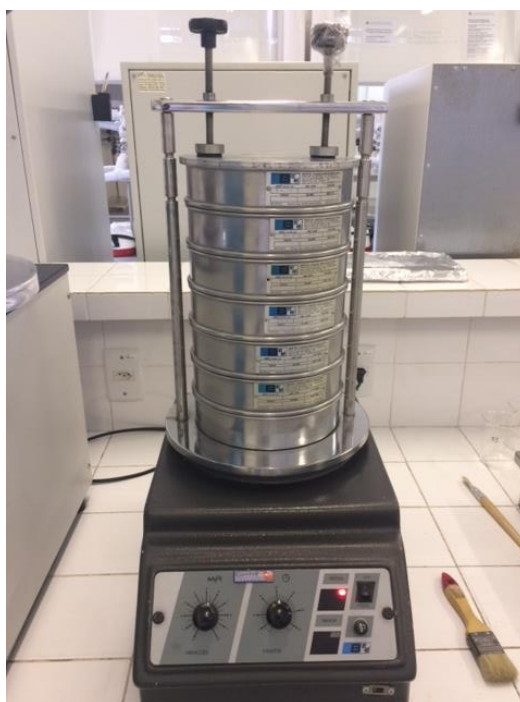
Figura 13. Análise granulométrica pelo método de peneiramento – jogo de peneiras com o agitador eletromagnético. Fonte: Autora.
