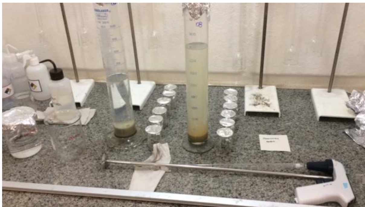
Figura 12. Análise granulométrica pelo método de pipetagem – provetas com material e jogo de béqueres. Fonte: Autora.
